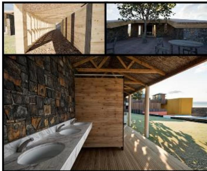
Nota: La madera es un elemento de construcción muy versátil, se observa la madera en el piso, modulo WC, vigas de madera, tijerales de manera.
