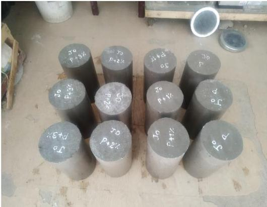
1. Muestras para ensayo a compresión
