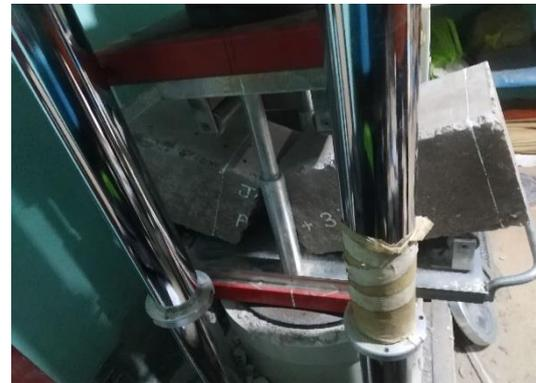
4. Verificación de rotura en tercio central de viga prismática
