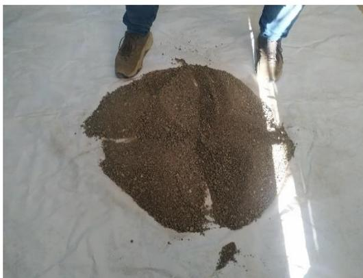
1. Cuarteo de agregado fino ASTM C29 / C29M – 17a
