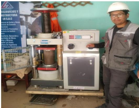
2. Prensa para ensayo a compresión.
