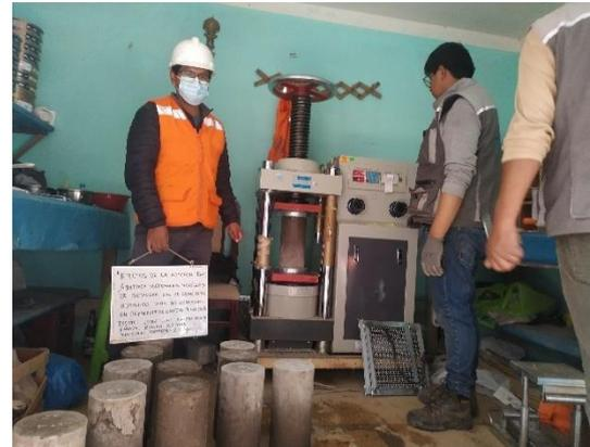
3. Ensayo de resistencia a compresión.
