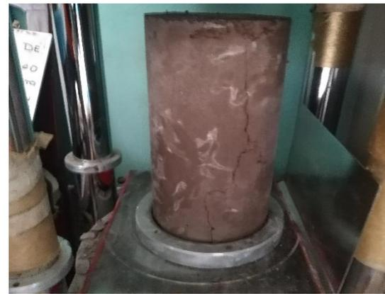
4. Verificación de tipo de rotura según la norma ASTM C39.
