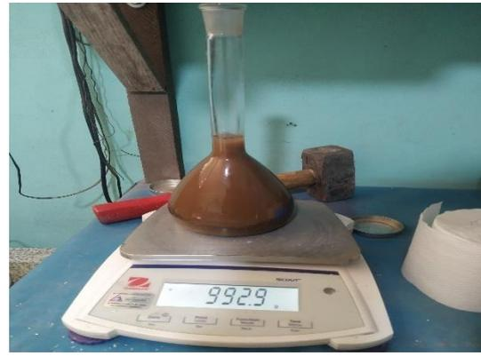
8. Determinación de la absorción de agregado fino
