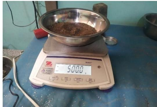
7. Determinación del peso específico de agregado
