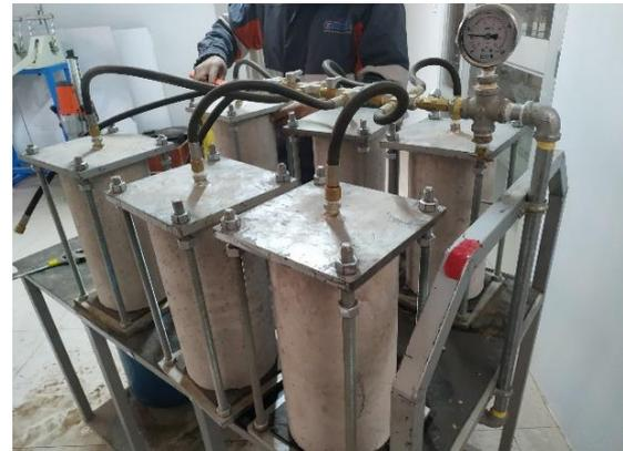
2. Equipo para ensayo de profundidad de penetración de agua bajo presión.
