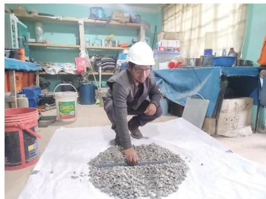
2. Cuarteo de agregado grueso ASTM C29 / C29M – 17a
