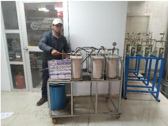
1. Ensayo de profundidad penetración de agua bajo presión.
