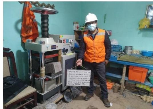
3. Rotura por flexión de muestra prismática de concreto
