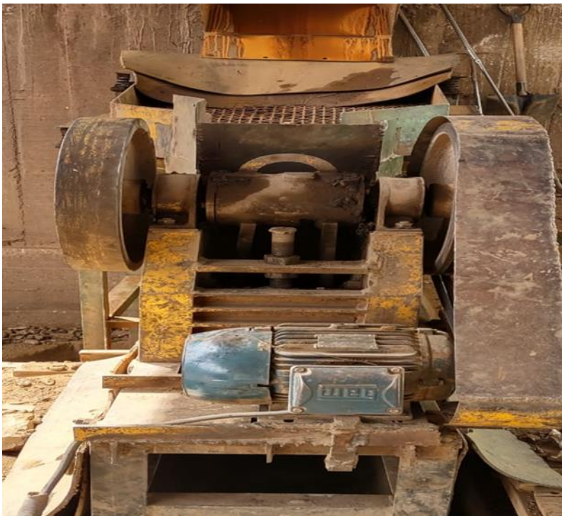
Chancadora de quijada 8" x 10" en sección de chancado
