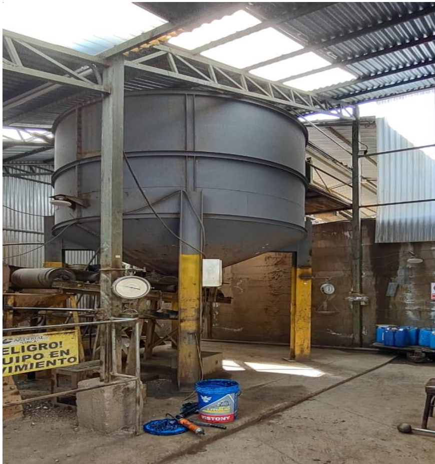
Tolva de finos para depositar mineral chancado
