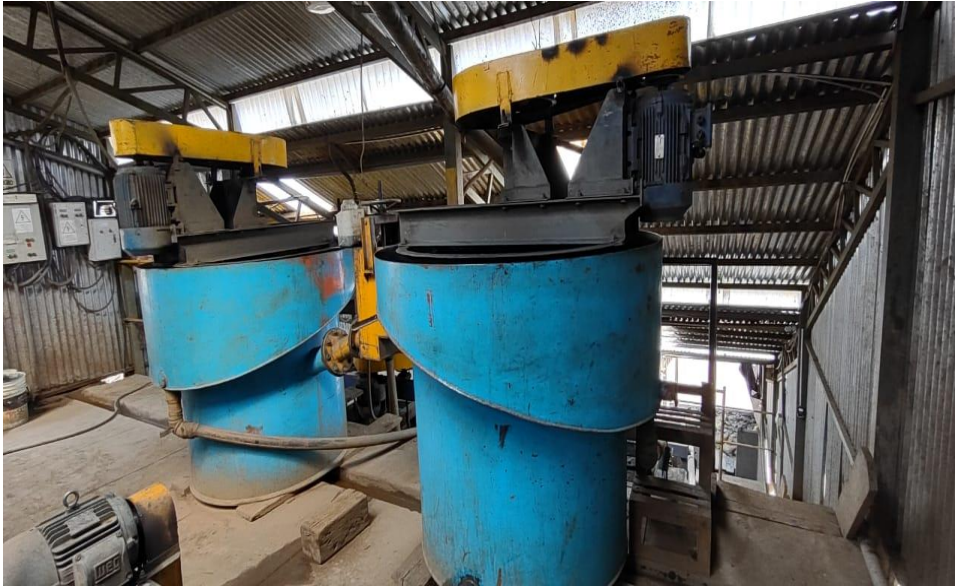
Celda Serrana N° 1 y N° 2 de 4' x 4' en circuito de flotación
