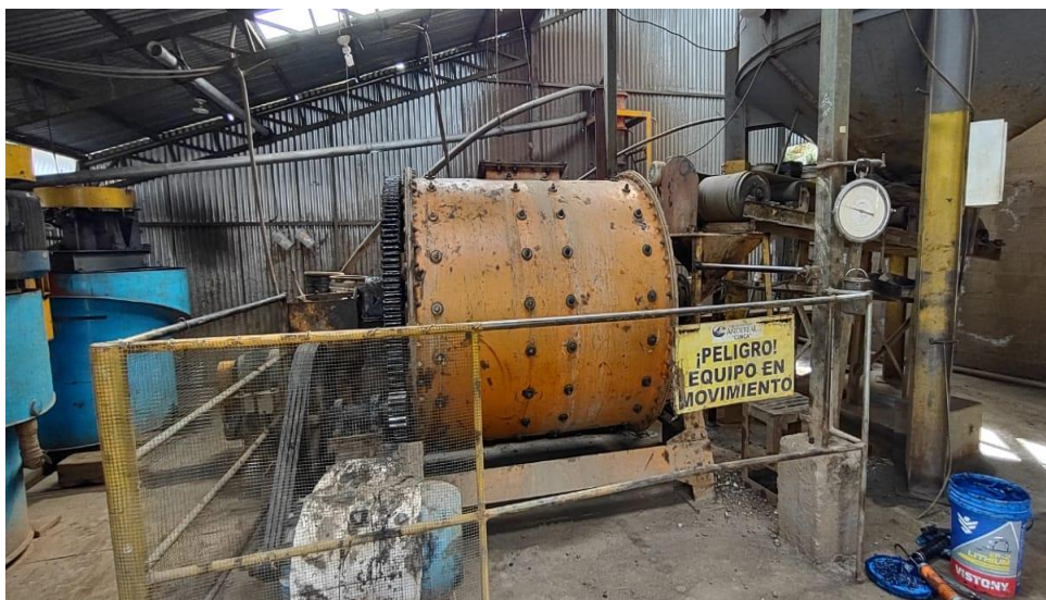
Molino de bolas 4' x 4' en sección de molienda
