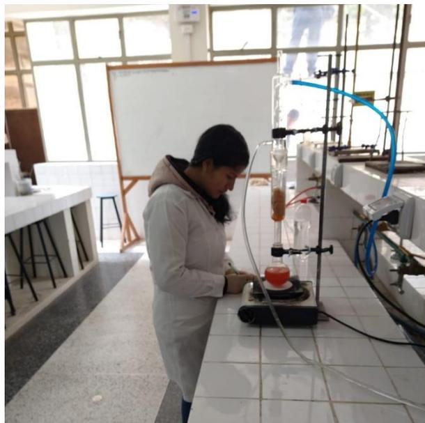
**Figura 8.4.** Método soxhlet Semillas de palta
