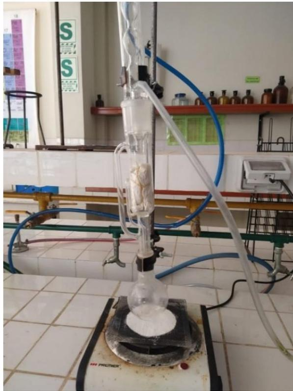
**Figura 8.3.** Método soxhlet semillas de durazno
