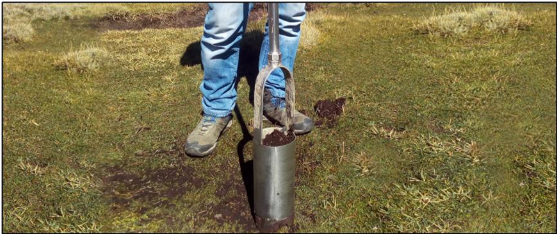
Nota. medición de la profundidad de la turba
