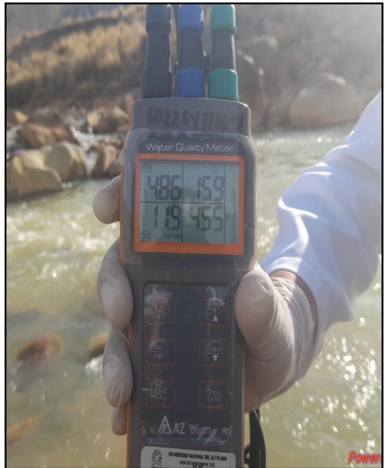
Fotografía N° 04. Medición de parámetros de campo
