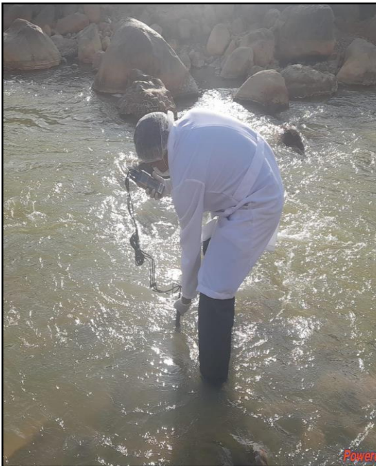
Fotografía N° 03. Monitoreo de calidad de agua con multiparámetro
