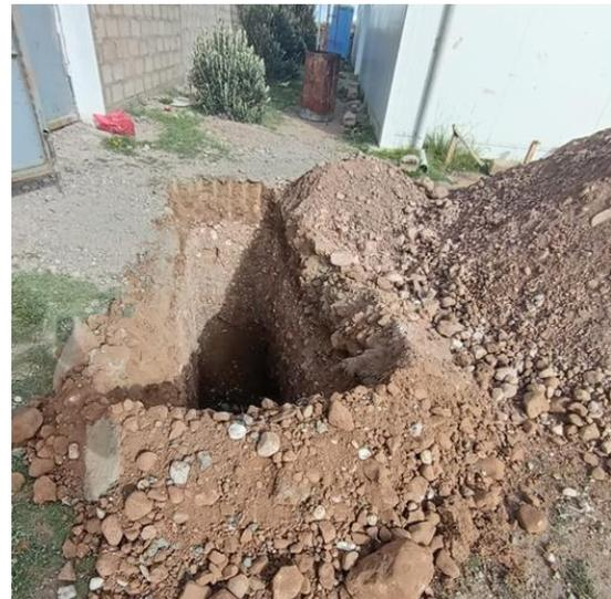
En la figura 20 se describe la estratigrafía de la calicata uno C-05 lo cual conforma de dos estratos superficialmente el estrato uno de espesor de 30cm se muestra materia orgánica con relleno y en el estrato dos se muestra estrato de espesor 2.70m con formado según la clasificación SUC Grava bien graduada y grava limosa estos determinados por laboratorio según el anexo 03. El suelo conforma de gravas mayor porcentaje de material grueso con cierto grado de alteración.
