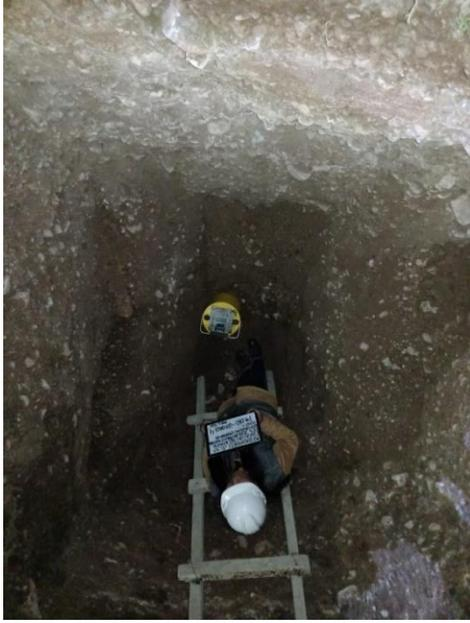
**FOTOGRAFIA 04**, se muestras ensayo de electromecánico de Geogauge
