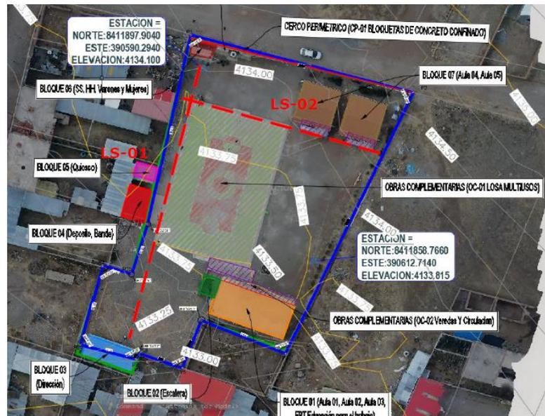
En la figura 24 se muestra la ubicación de los trazos del ensayo refracción sísmica que se ha proyectado según al lugar donde se ubicara donde se planteara las zapatas.
