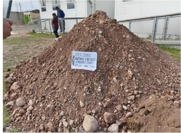
En la figura 19 se describe la estratigrafía de la calicata uno C-04 lo cual conforma de dos estratos superficialmente el estrato uno de espesor de 30cm se muestra materia orgánica con relleno y en el estrato dos se muestra estrato de espesor 2.70 con formado según la clasificación SUC Grava mal graduada y grava arcilloso, conforma por gravas redondeados con índice plasticidad baja estos determinados por laboratorio según el anexo 03.
