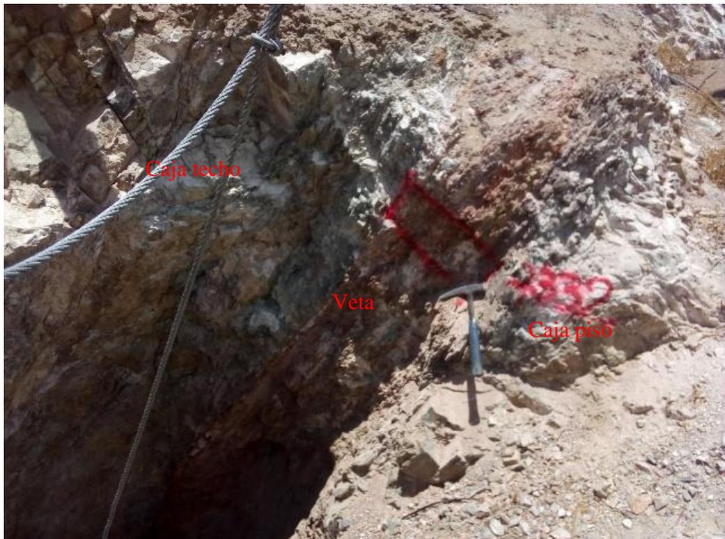
Nota: en la figura 17, la veta Santa Rosa presenta un azimut  $N115^\circ$  y buzamiento:  $57^\circ NE$  y una potencia de 0.10 a 0.30m
