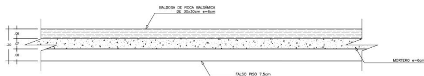
DETALLE DE ENCHAPADO EN PIEDRA - VESTÍBULO
