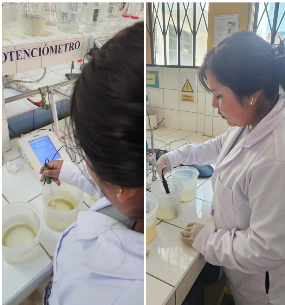
B9. Medición de los parámetros Físicoquímicos (pH, SST, Turbiedad)
