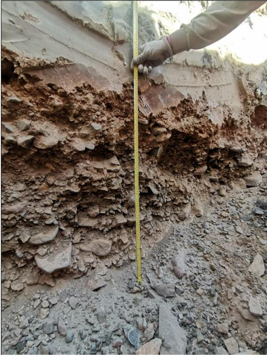
Nota: Fotografía de la identificación y medición de estratos de la calicata realizada.
