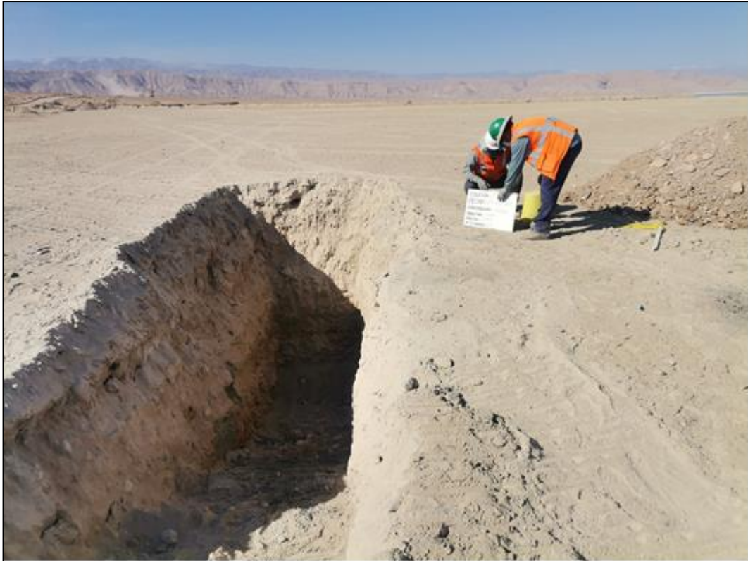
Nota: Fotografía de la calicata realizada.
