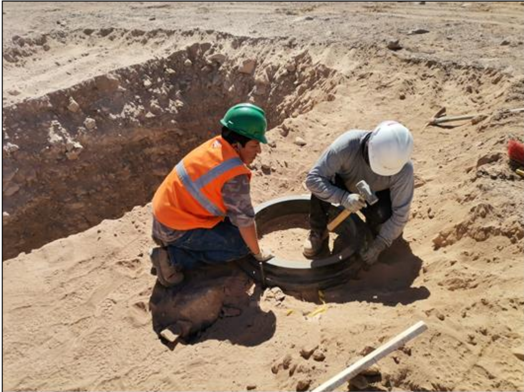
Nota: Fotografía de la preparación para realizar el ensayo de Reemplazo de Agua.
