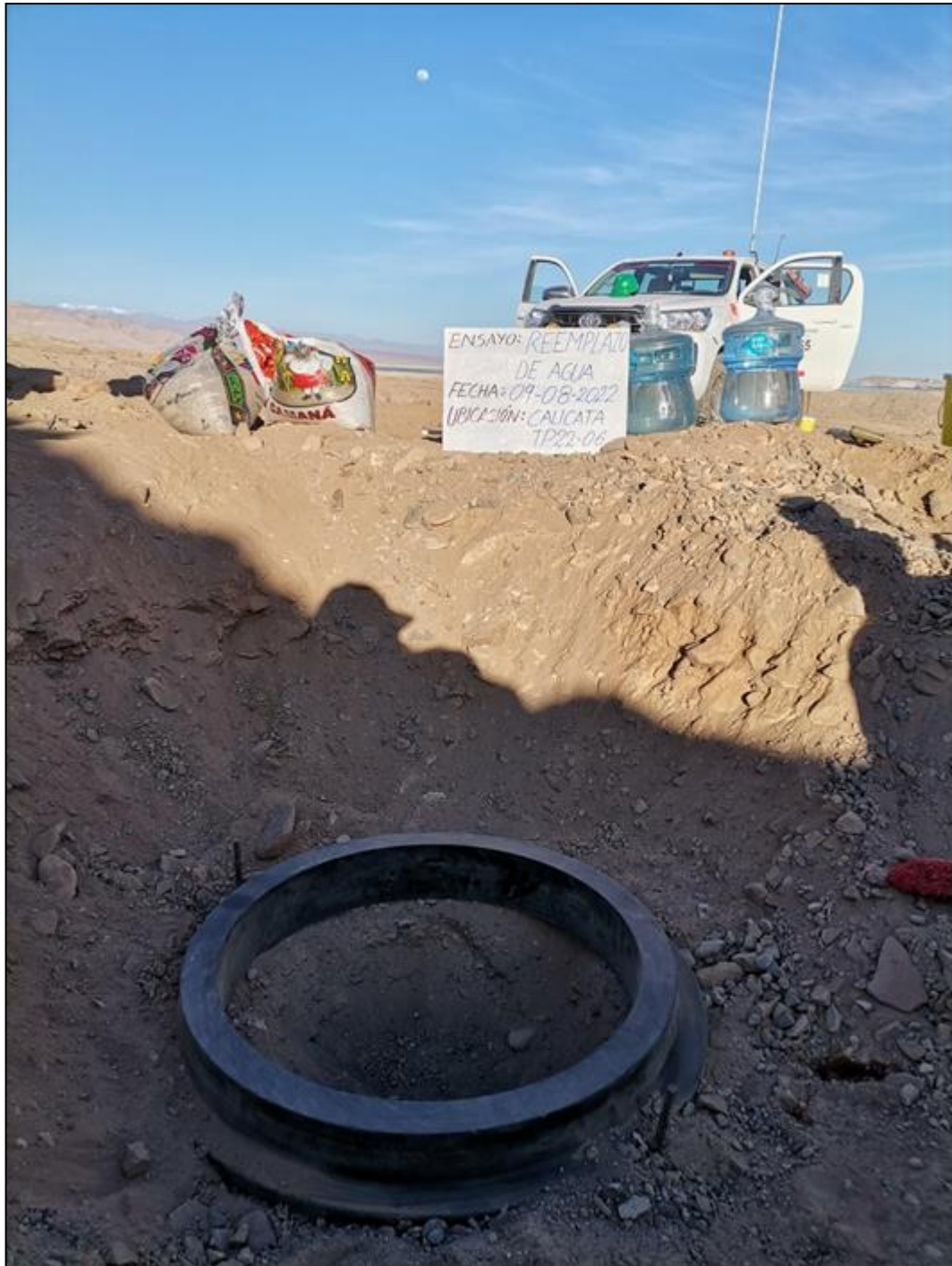
Nota: Fotografía de la preparación para realizar el ensayo de Reemplazo de Agua.
