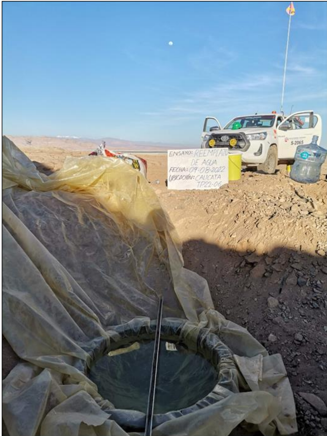
Nota: Fotografía del ensayo de Reemplazo de Agua.
