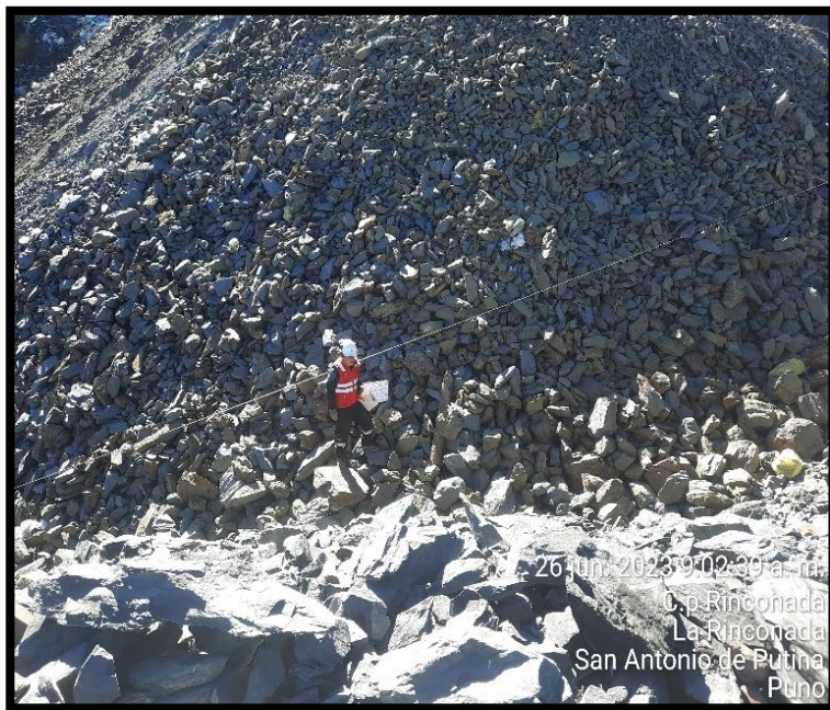
Fotografía 2. Se observa el desmonte monte (roca pizarra)
