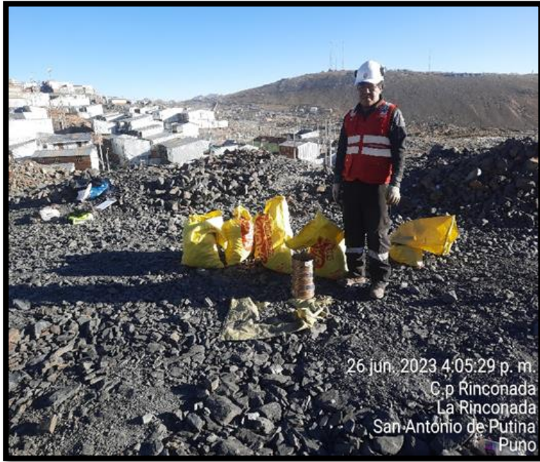
Fotografía 1. Extracción de muestras del agregado grueso (desmonte minero)
