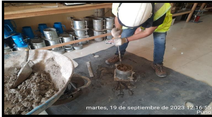
Fotografía 14. Ensayo del concreto en su estado fresco, compacto y suelto.
