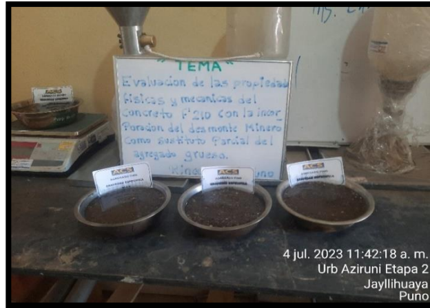
Fotografía 8. Ensayo de absorción y peso específico del agregado fino.
