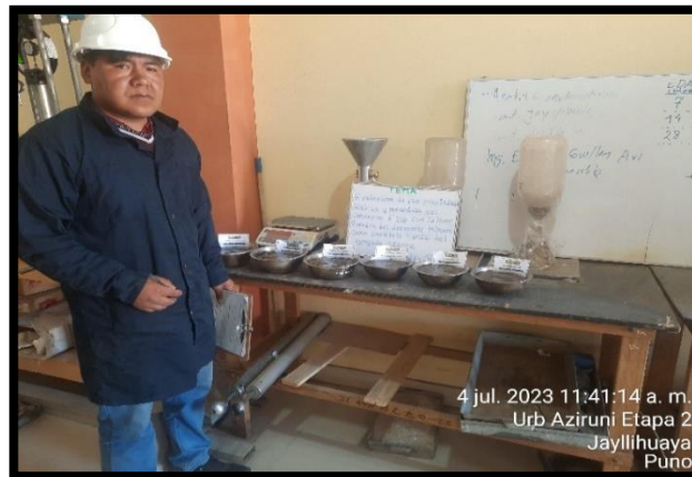
Fotografía 7. Ensayo de absorción y peso específico del agregado natural.
