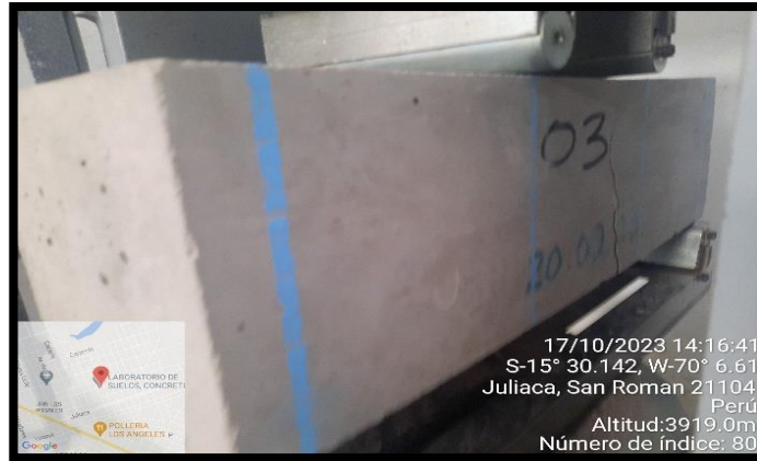
Fotografía 23. Se observa la vigueta en la maquina de compresion.
