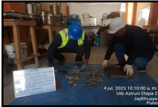
Fotografía 5. Se observa el contenido de humedad
