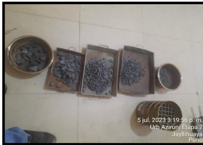
Fotografía 6. Ensayo de la granulometría del agregado grueso (desmonte minero)
