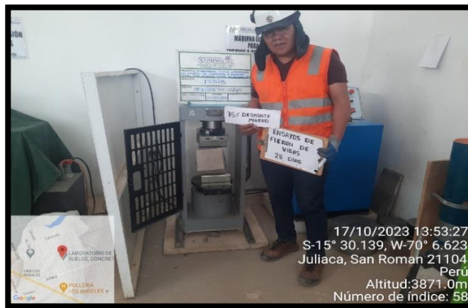
Fotografía 21. Se observa en ensayo a flexion de viguetas
