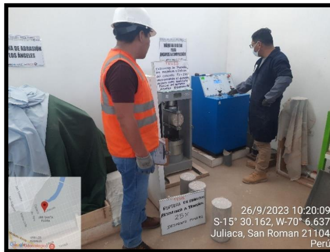
Fotografía 18. Se observa el ensayo de rotura a tracción de briqueta
