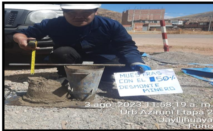
Fotografía 15. Se observa el ensayo Slump del concreto con dosificación del 50% DM.
