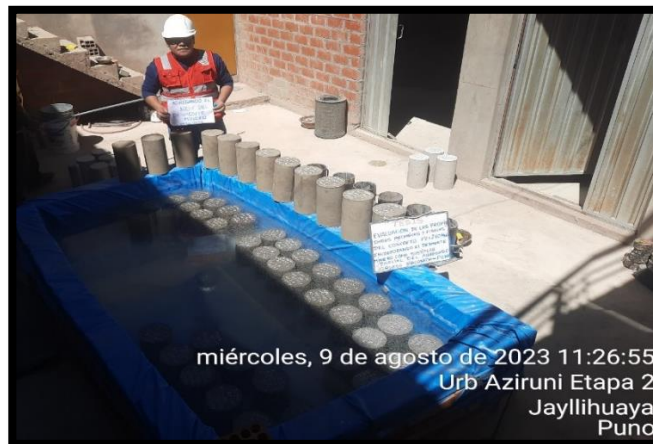
Fotografía 13. Se observa el curado de las briquetas.
