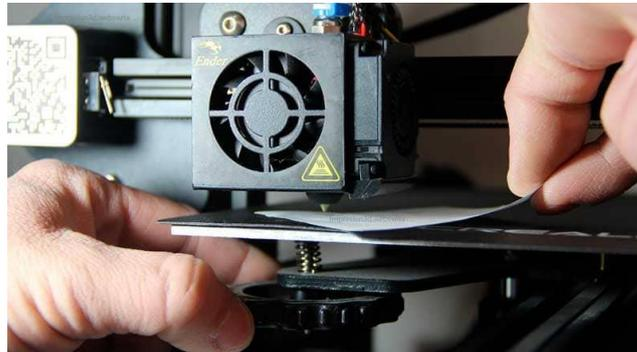
Nota. Calibracion de la plataforma de impresión manualmente. Adaptado de (Venencia, 2024).
