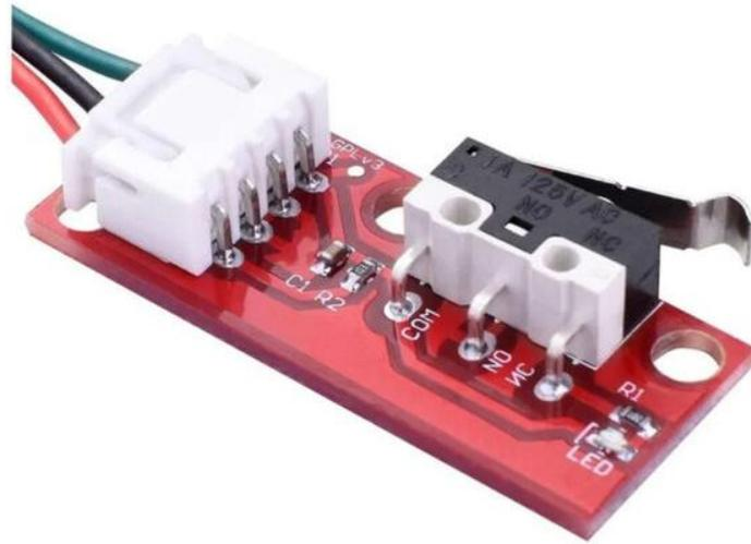
Nota. Final de carrera de una impresora 3D. Adaptado de (Moviltronics, 2024).
