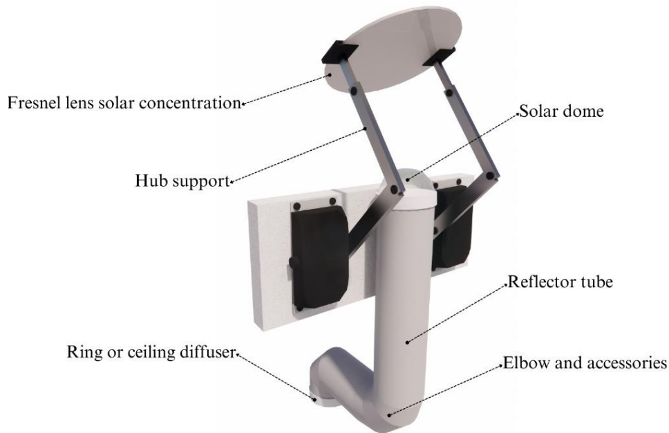
Figura 2 Diseño del prototipo del Sistema reflectores con tubos solares.
