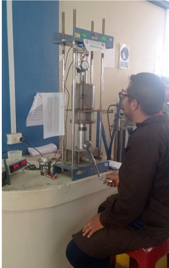
Rotura de Moldes de CBR
