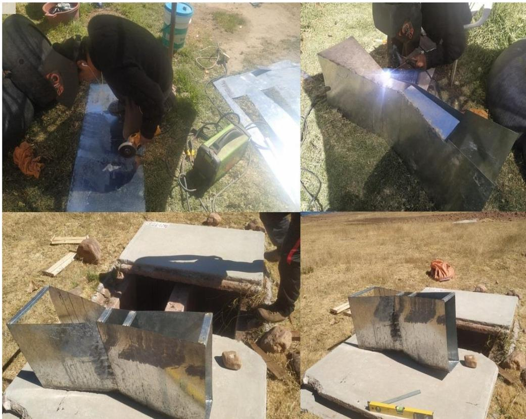
Nota. Se aprecia el corte de piezas, soldadura en la parte exterior y el producto final.
