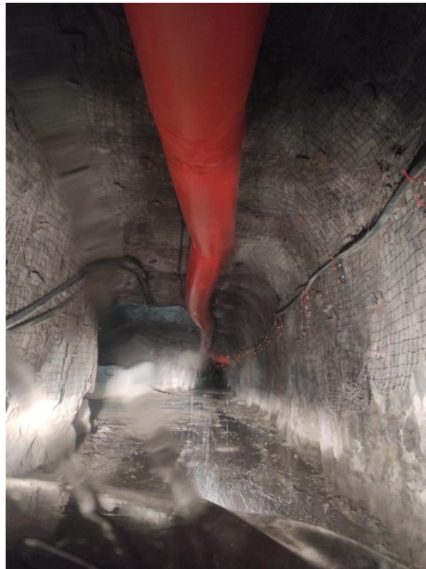
Fotografía 14. Manga de ventilación para la distribución del aire fresco y la extracción de gases y partículas contaminantes (Segunda toma).
