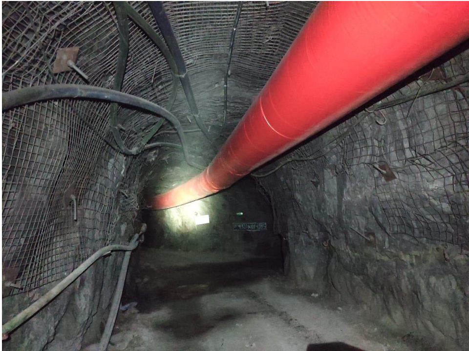
Fotografía 15. Manga de ventilación para la distribución del aire fresco y la extracción de gases y partículas contaminantes (Tercera toma).
