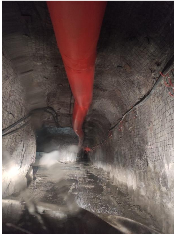
Fotografía 14. Manga de ventilación para la distribución del aire fresco y la extracción de gases y partículas contaminantes (Segunda toma).
