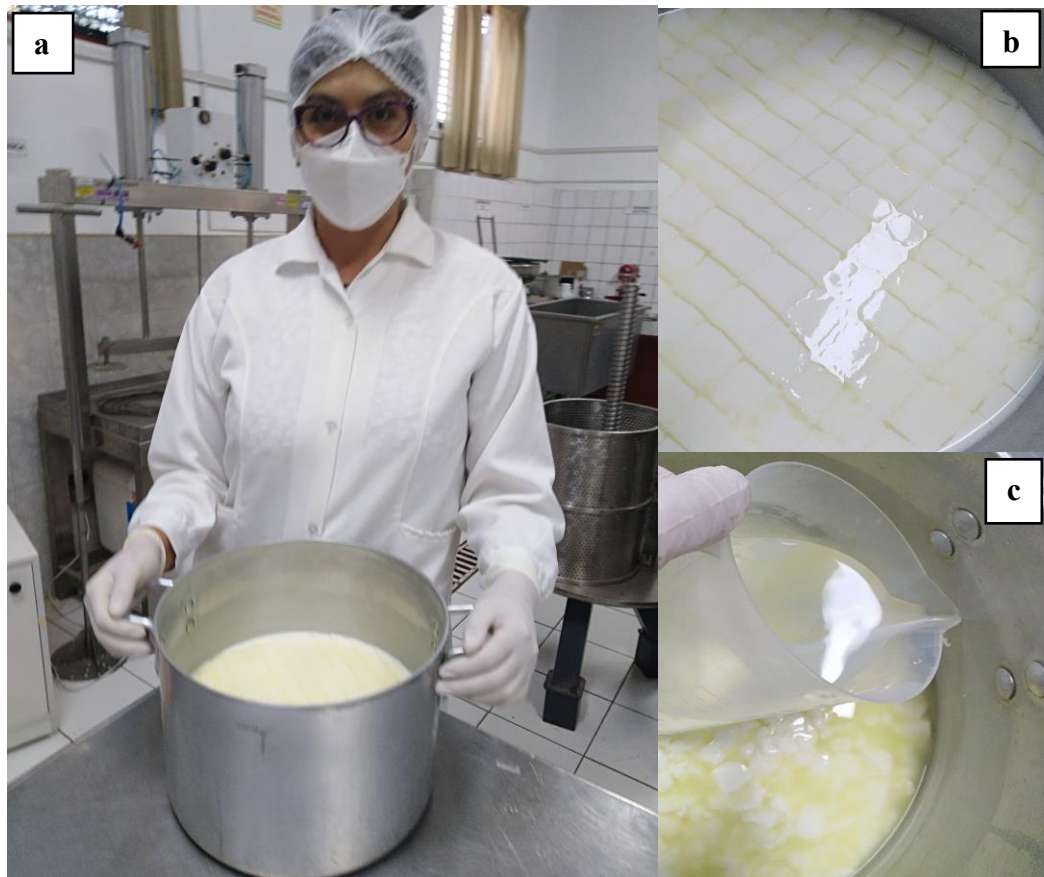
Figura 1: a) Elaboración de queso andino a nivel laboratorio (Laboratorio de Tecnología de Alimentos). b) Corte de cuajada para elaboración de queso andino y c) Escalado de la cuajada para queso andino a 40 °C.
