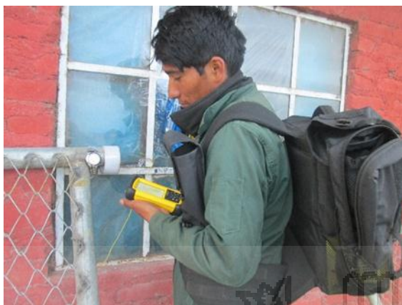
Foto 5. Medición de metano los últimos tres minutos de los diez minutos encerrado la vaca.
