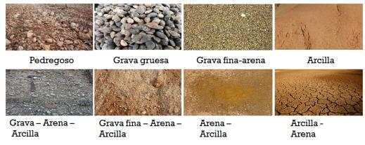
Nota: Tamaño de las particulas de suelos desde un suelos granular hasta un suelo arcilloso. Fuente: CFAPE.
