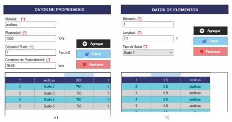
Nota: En figura a) se muestra la interfaz para el ingreso de datos respecto a tipo de suelos y en la figura b) se muestra la interfaz para la discretización.
