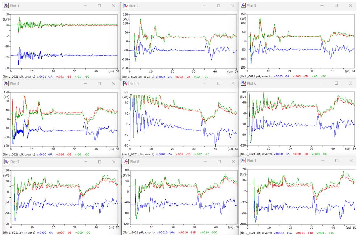
*Nota.* En esta gráfica se muestra el comportamiento de transitorios en el escenario de Puesta a Tierra actual para impacto de rayo en el conductor de guarda de la estructura 7, considerando la norma IEEE distribution & CIGRE C4.407, resultados obtenidos utilizando ATPDraw.
