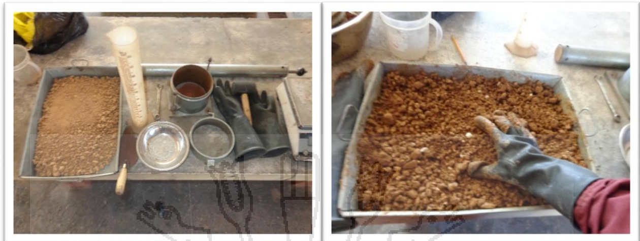
Ilustración 20 Equipos, Materiales y mezclado de Muestra con Humedad Optima y Cal
