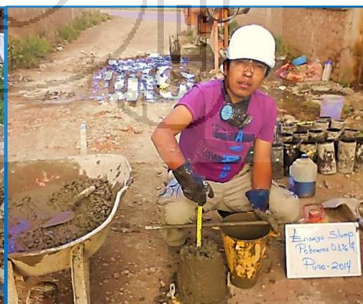
**FIGURA 3.33:** PRUEBA DE SLUMP: 4.5" CONCRETO CON 0.1 % ADICIÓN DE POLÍMEROS SUPERABSORBENTES.
