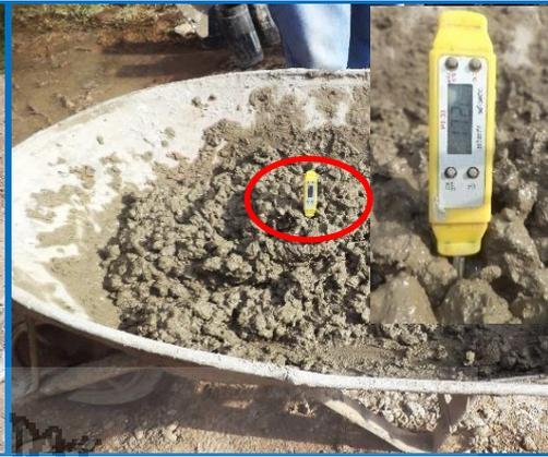
FIGURA 3.27: CONTROL DE TEMPERATURA DEL CONCRETO CON 0.2% DE P.S. 17.2 °C.
