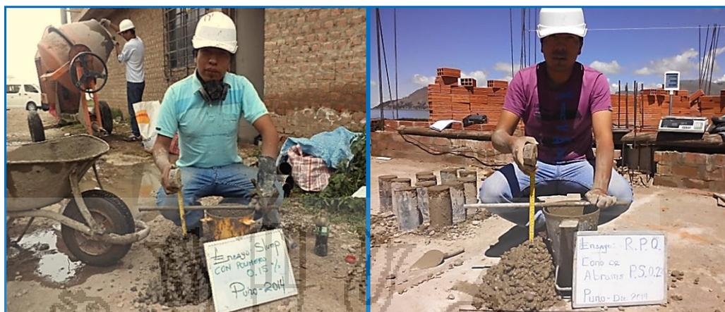
**FIGURA 3.34:** PRUEBA DE SLUMP: 5.1" CONCRETO CON 0.15% ADICIÓN DE POLÍMEROS SUPERABSORBENTES.
