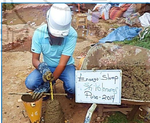
**FIGURA 3.32:** PRUEBA DE SLUMP: 3" CONCRETO SIN ADICIÓN DE POLÍMEROS SUPERABSORBENTES.
