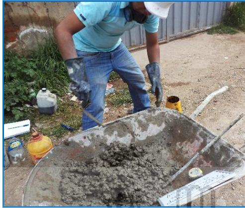
FIGURA 3.26: CONCRETO DE DISEÑO INICIAL SIN ADICIÓN DE POLÍMEROS SUPERABSORBENTES.
