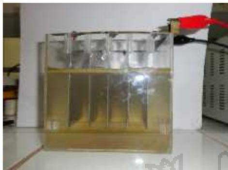
**Imagen 5.** Tratamiento por electrocoagulación de la muestras de agua residual.
