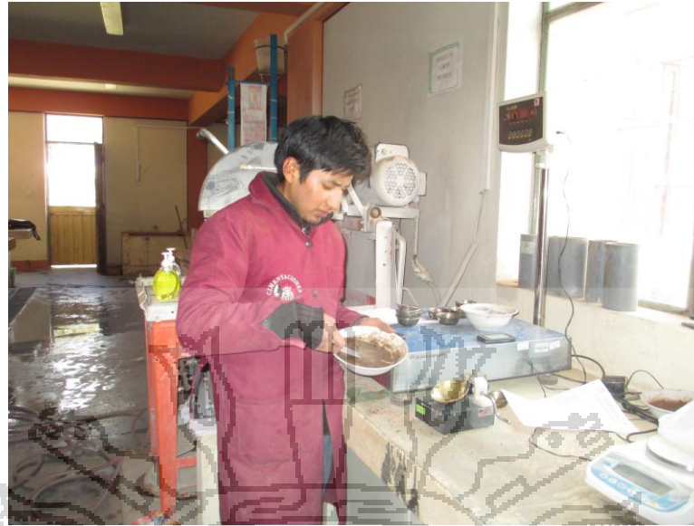
IMAGEN 39: Mezclado de la muestra con agua hasta obtener la consistencia de una pasta espesa y suave.
