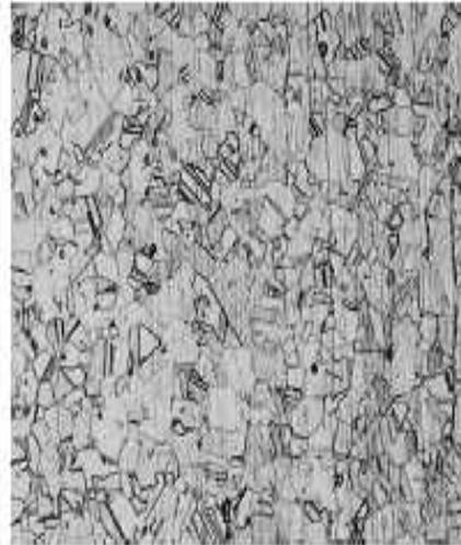
Microestructura típica del tipo 201, 200X. Ataque químico con reactivo glicerregia.
