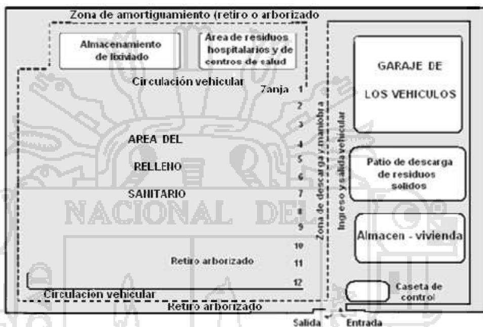
**Figura 3.5: Planta de Tratamiento de Residuos Sólidos de un Sistema Integrado de Tratamiento y Disposición Final de Residuos Sólidos**
