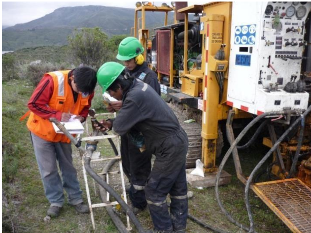
FOTOGRAFIA N° 9. Sondaje PPA-05, Realización de ensayo de permeabilidad tipo Lefranc.
