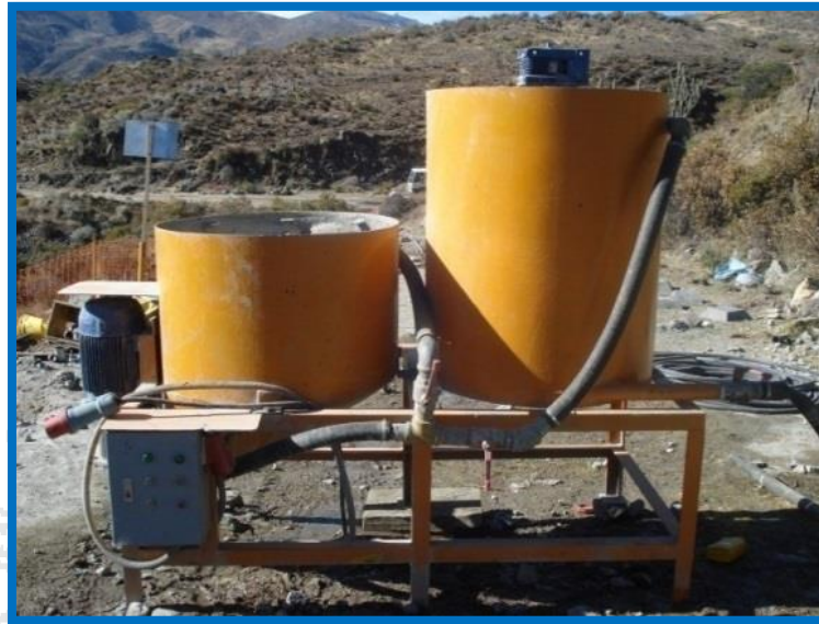
FIGURA N° 6: EN LA VISTA SE OBSERVA ELMESCLADOR Y AGITADOR
