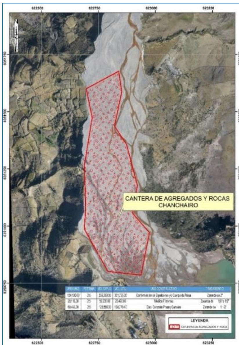
FIGURA N° 21: UBICACIÓN DE CANTERAS
