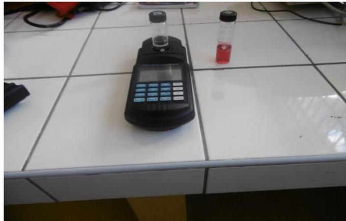
Fotografía 13. Análisis de fluoruro de líquido sobrenadante
