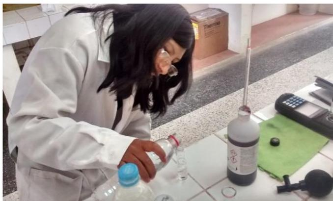
Fotografía 4. Preparación de muestra para análisis de fluoruro por el método de HACH
