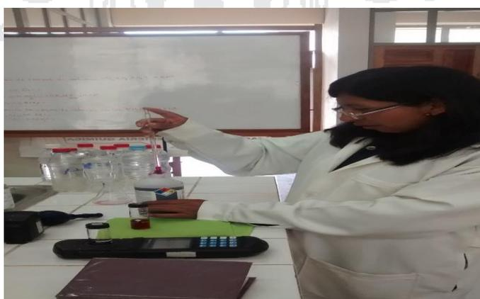
Fotografía 5. Análisis de fluoruro por el método de HACH
