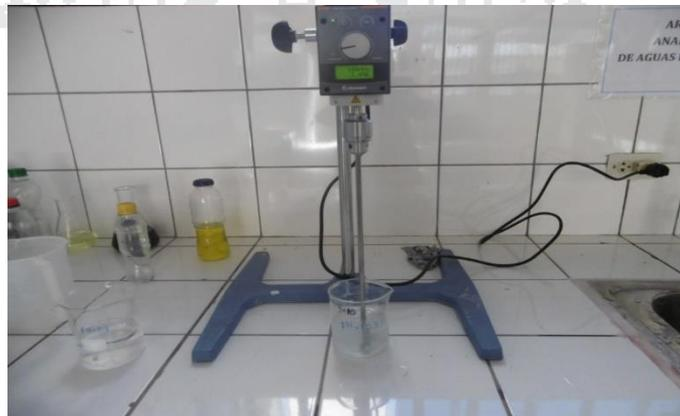
Fotografía 11. Proceso de floculación con policloruro de aluminio
