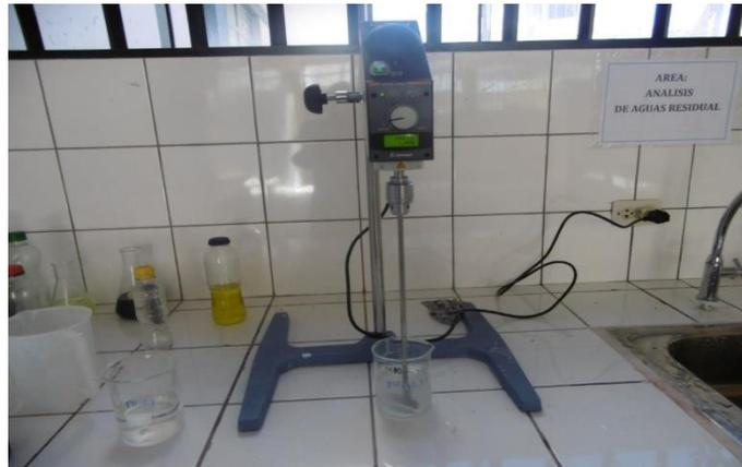
Fotografía 10. Proceso de Floculación con lechada de cal
