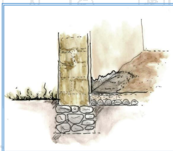
Ilustración 6: Contrafuertes en Sobre Cimiento de Piedra
