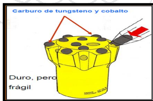
Figura N° 8: Broca utilizada para la perforación.
