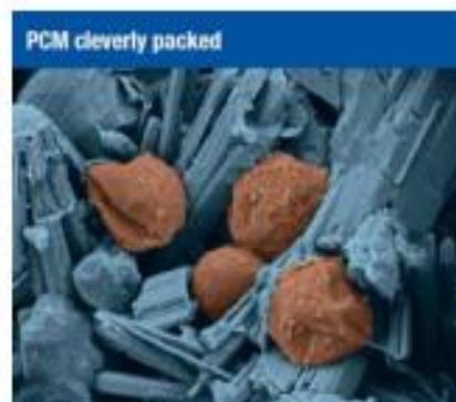
Las temperaturas de cambio de estado más adecuadas son aquellas ligeramente por encima de la de bienestar, entre 21 y 25°C. Si la temperatura es muy alta, la sustancia podría no llegar a iniciar el proceso de licuación por no recibir suficiente energía, y si es muy baja, cederá la energía a una temperatura excesivamente fría.
