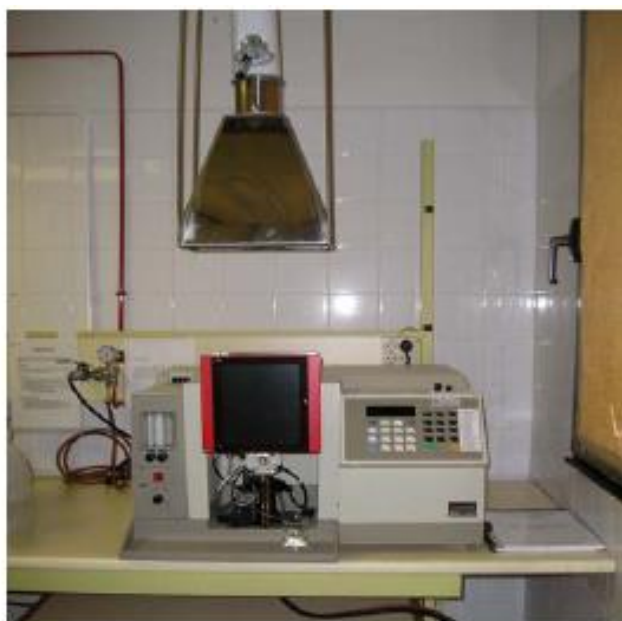
Figura: Equipo Perkin Elmer 3110B. Espectrómetro de Emisión Atómica
