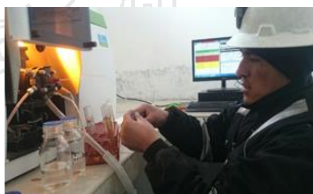
FOTO N°06: Análisis de muestras en equipo de absorción atómica.
