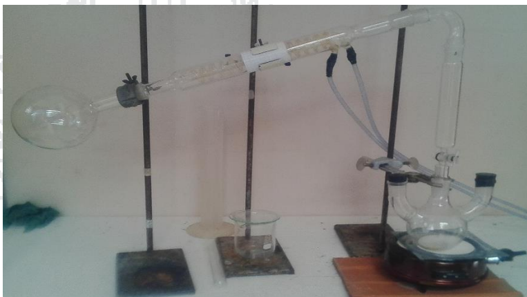
Figura 8: Equipo utilizado para la destilación simple.
