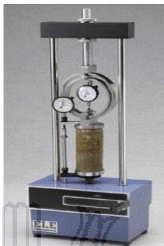
Fig 6. Prensa de compresión (Valdivia, 2004).
