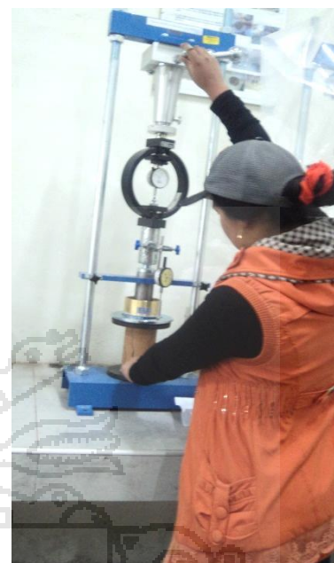
PROCESO EN EL QUE SE SOMETE A LA PROBETA EN LA PRENSA DE COMPRESION SIMPLE
