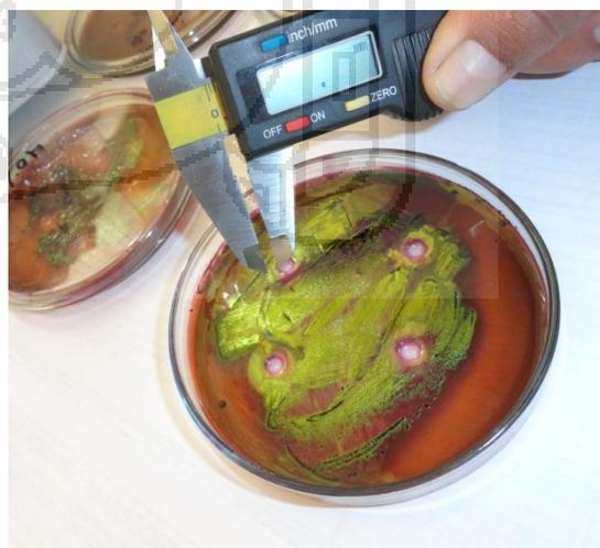
Determinación de la distancia de halo de inhibición (mm).
