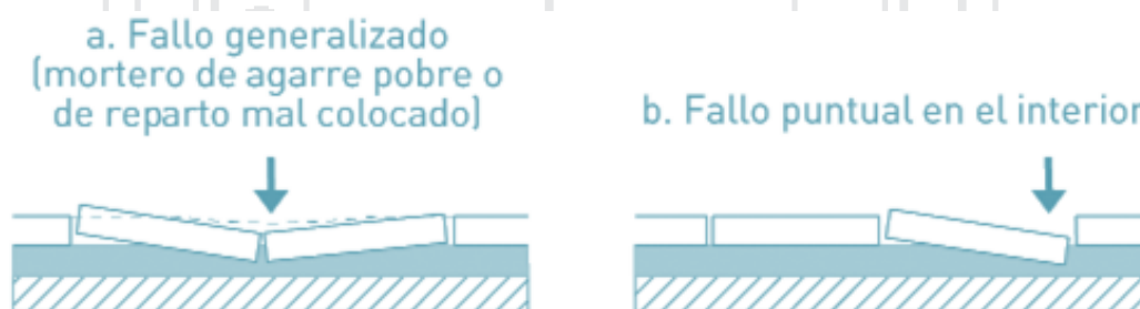
Ilustración 16. Patologías del Pavimento
