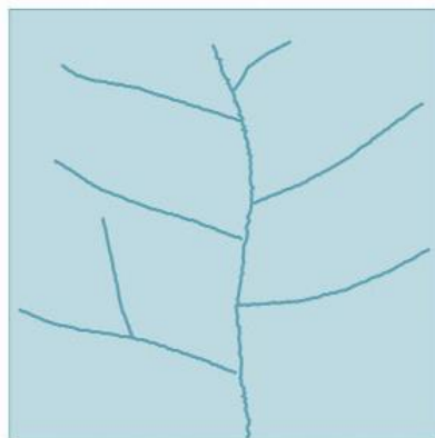
Ilustración 35. Patología de Falla de Adherencia
