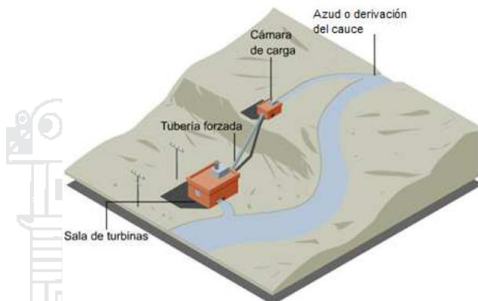
Figura 1: Centrales de pasada o filo de agua.
