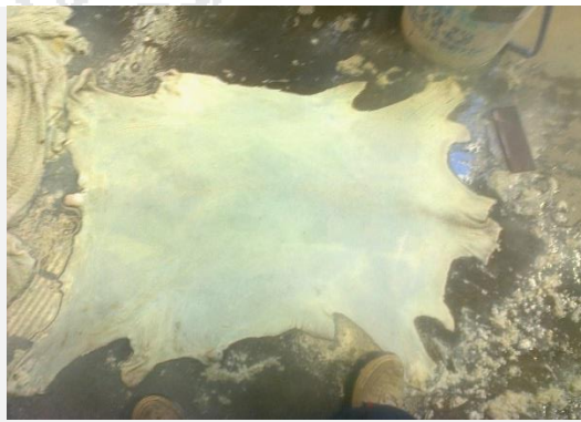
Foto N° 14. Proceso de descarne de las pieles
