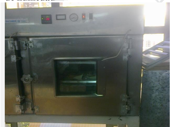
Foto N°47. Estufa para la determinación de humedad
