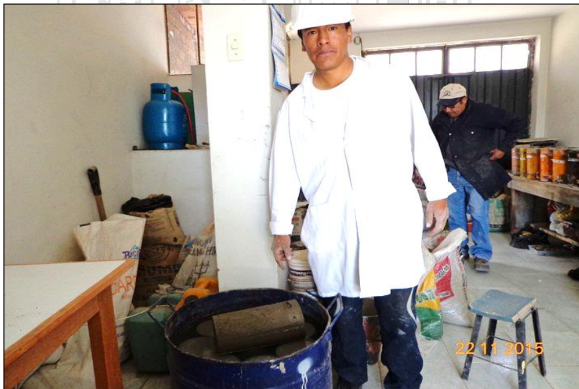
Fotografía N° 008: Curado de concreto endurecido en poza de cilindro
