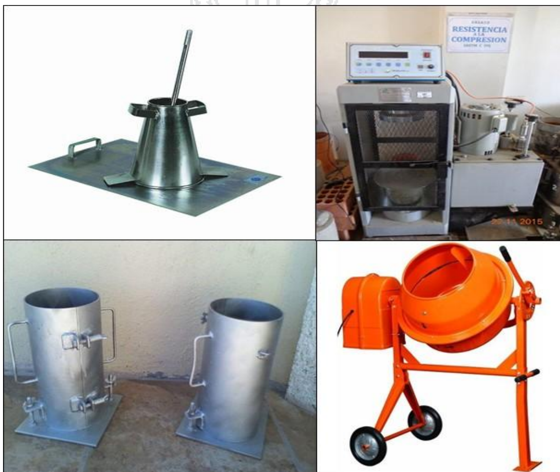
Figura 4. Cono de Abrams, prensa hidráulica, cilindros de concreto y mezcladora.
