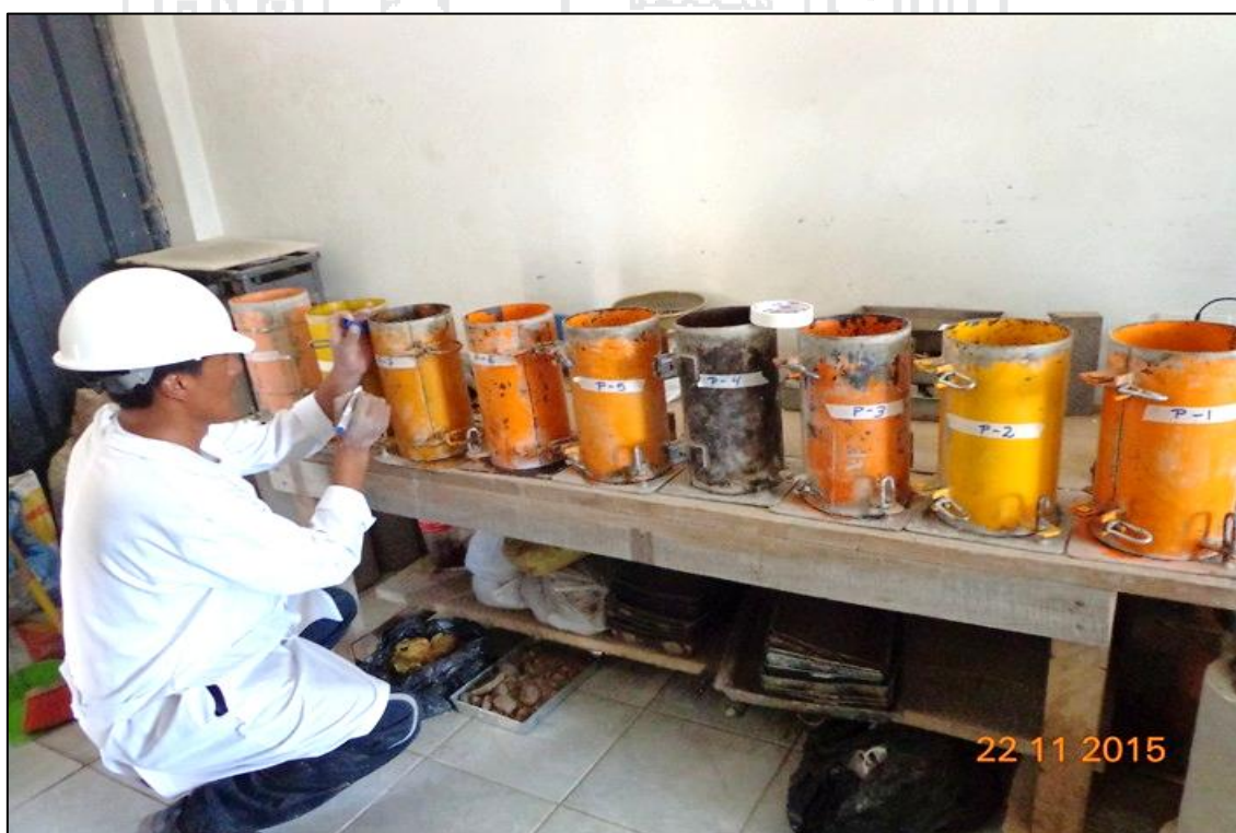
Fotografía N° 004: Etiquetado de Moldes Metálicos para vaciado de concreto
