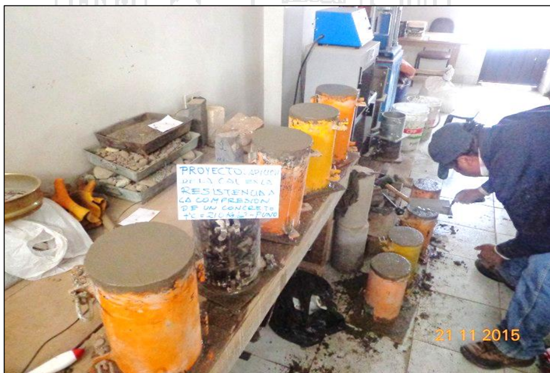
Fotografía N° 006: Acabado de concreto en los Moldes Metálicos
