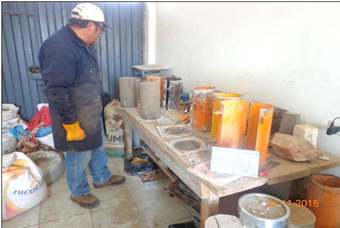
Fotografía N° 007: Desmolde de concreto endurecido después de 24 horas
