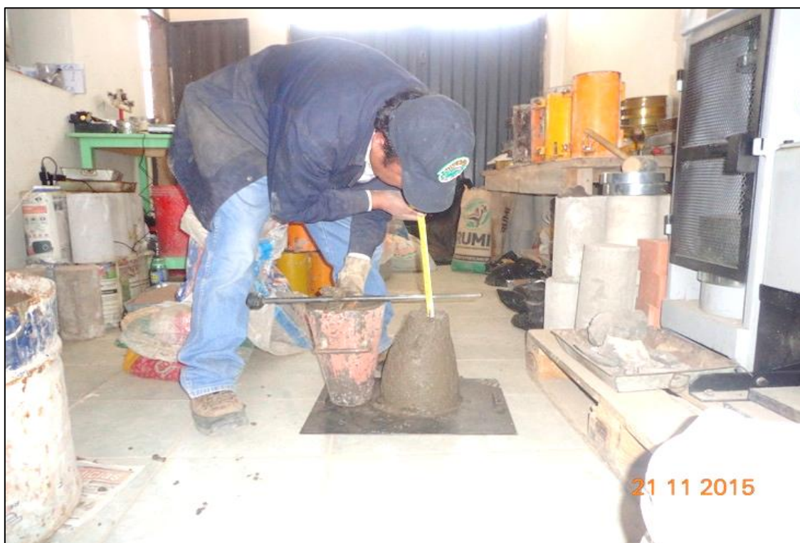
Fotografía N° 003: control de concreto con cono de Abrams
