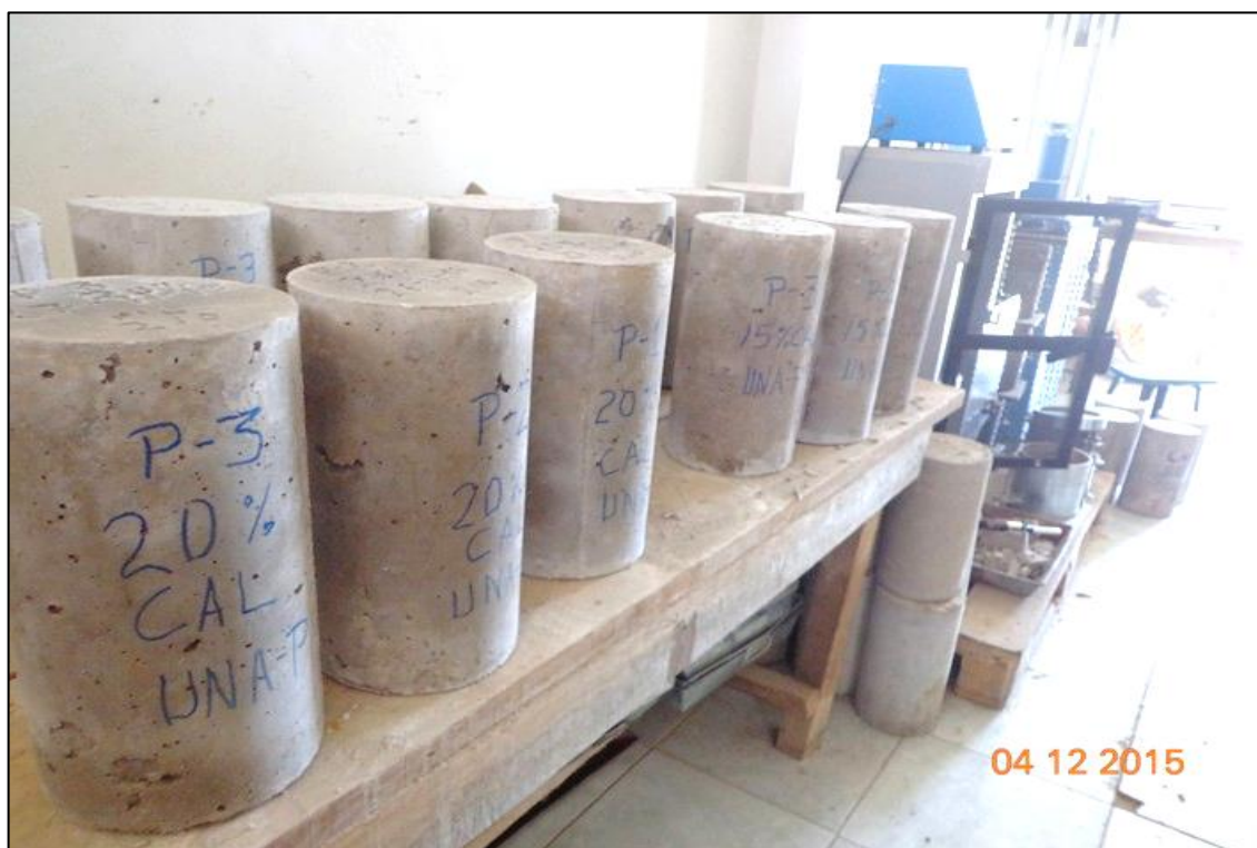
Fotografía Nº 009: Concreto moldeado maduro listo para la prueba de compresión
