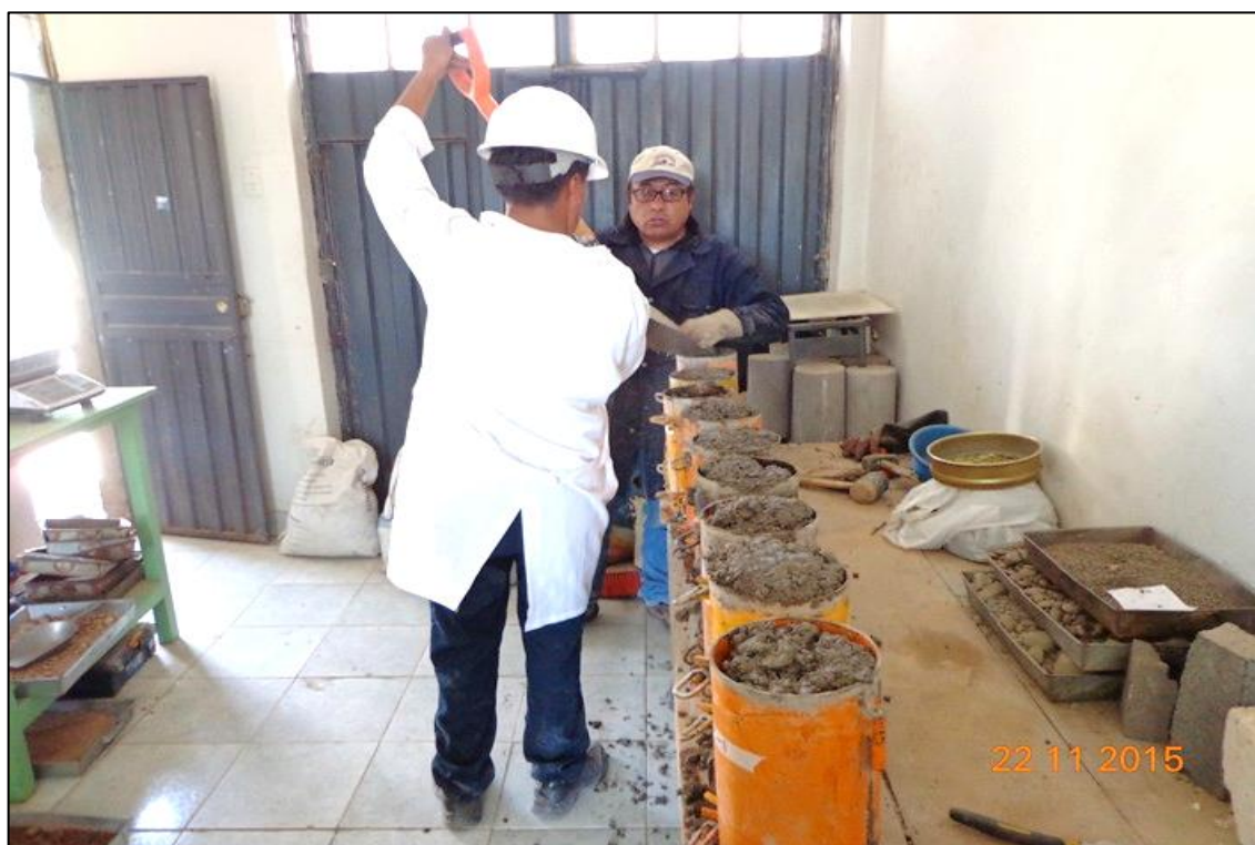
Fotografía N° 005: vaciado de concreto en los Moldes Metálicos
