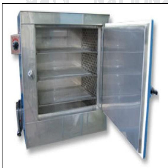
Nº 09: Horno eléctrico para materiales
