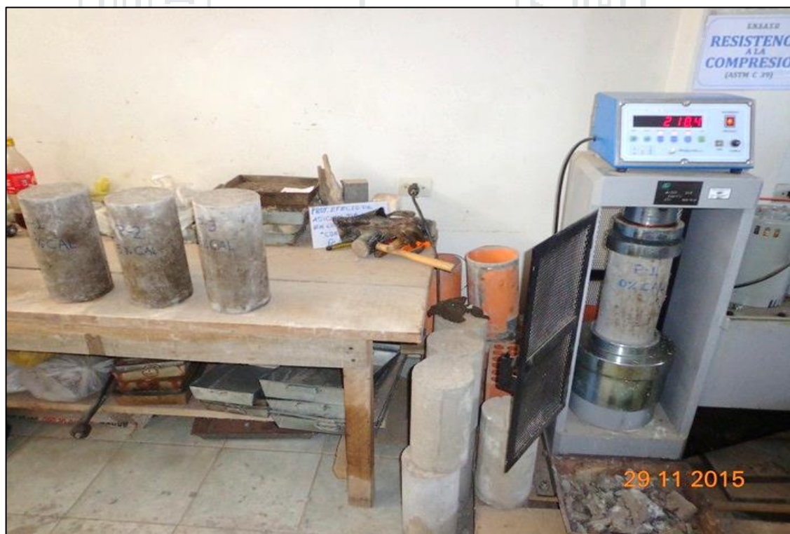
Fotografía Nº 010: Prueba de compresión
