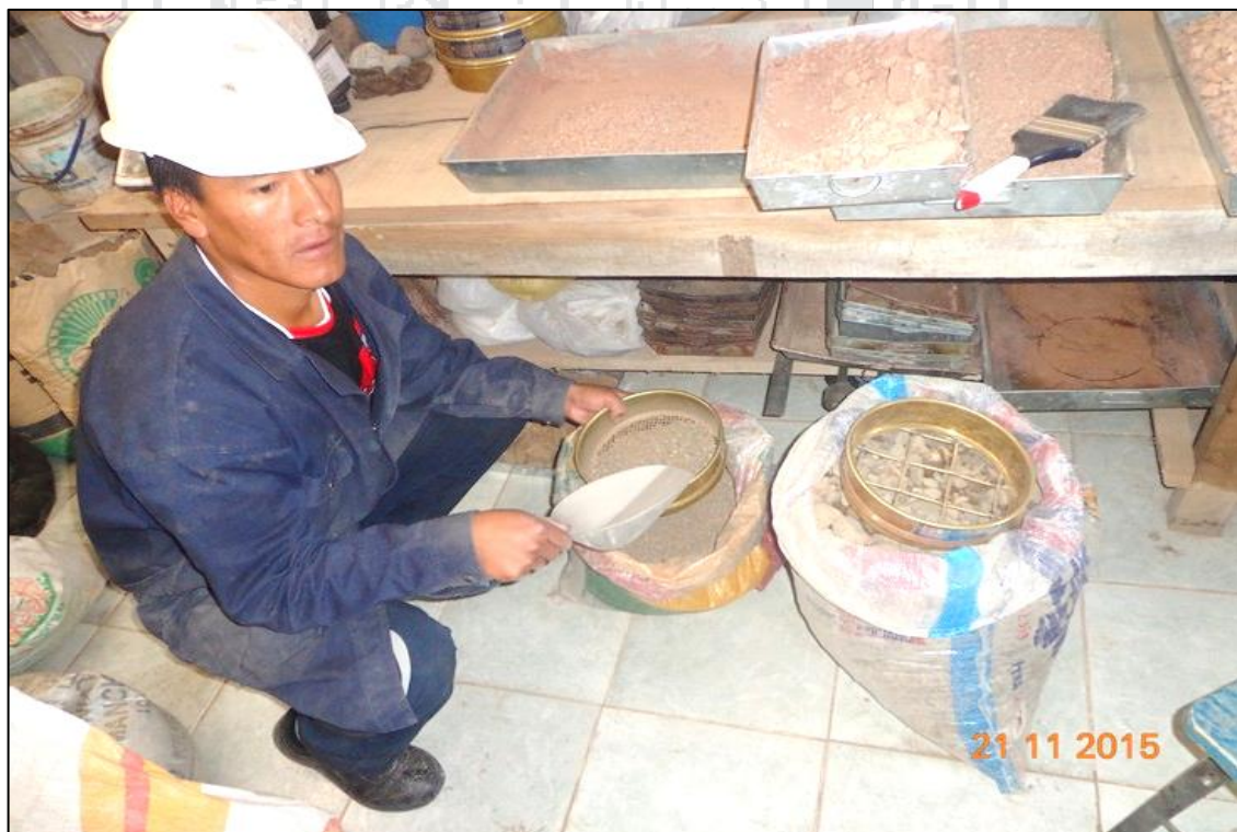
Fotografía Nº 002: Tamizado de agregados
