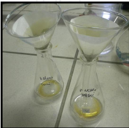
**Filtración de muestras para HPLC**
