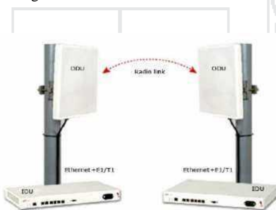
FIGURA N° 25: Arquitectura de sistema Winlink 1000.
