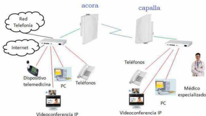
FIGURA N° 24: Esquema general de red de telemedicina.
