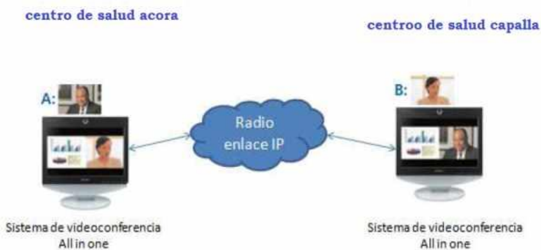
FIGURA N° 36: Diagrama de red videoconferencia IP
