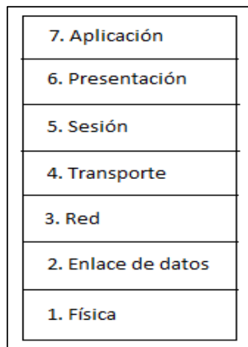
Figura 1: Capas del modelo OSI Fuente: Organización Internacional de Normalización (ISO) Elaboración: Propia
