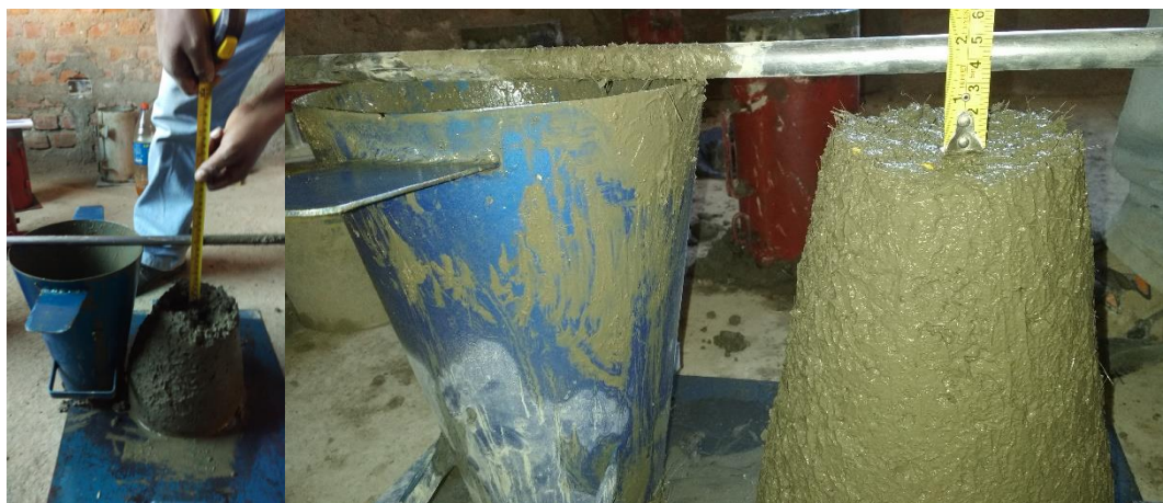
Figura 3. 18 Ensayo de revenimiento o asentamiento en el cono de Abrams
