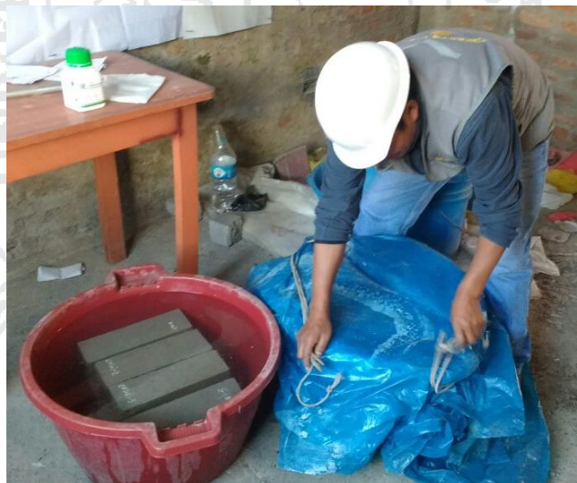
Figura 3. 32 Almacenamiento de los especímenes (vigas de expansión).
