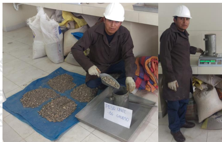
Figura 3. 6 Peso unitario suelto y compacto del agregado grueso
