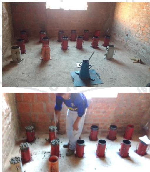
Figura 3. 13 Elaboración de probetas cilíndricas
