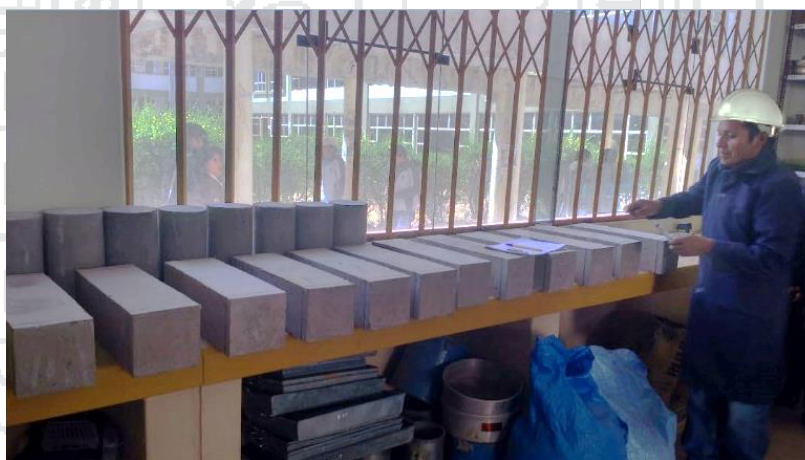
Figura 1. 2 Testigos para ensayo de flexión.
