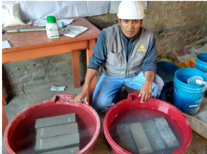
Figura 3. 31 Inmersión de los especímenes (vigas de expansión) en la solución de sulfato
