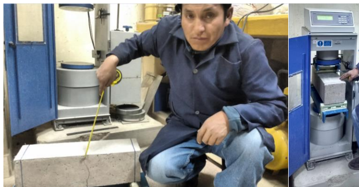
Figura 3. 25 Proceso de rotura a flexión.
