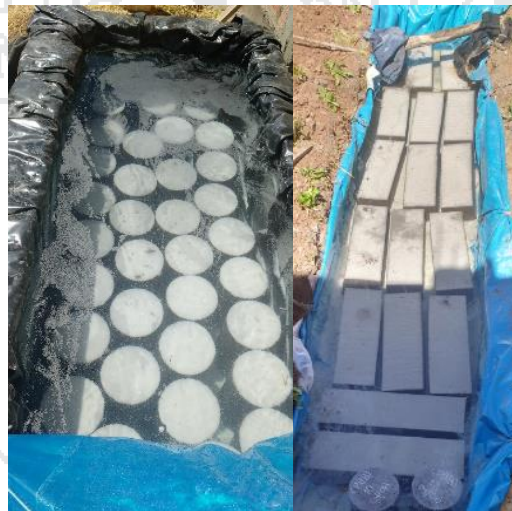
Figura 3. 16 Curado de especímenes de prueba
