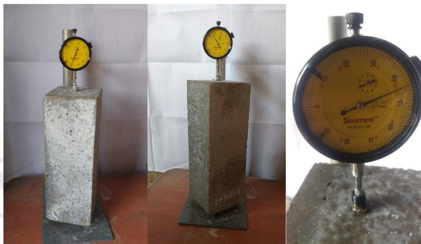
Figura 3.33 Obtención de lecturas comparativas en los especímenes (vigas de expansión).
