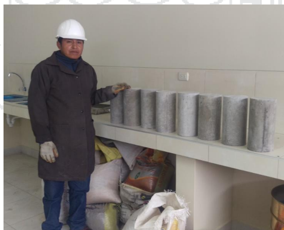
Figura 1. 1 Testigos para ensayo de compresión simple.
