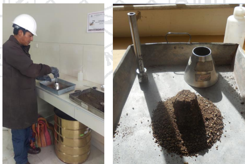
Figura 3. 3 Primer desmoronamiento, estado S.S.S.
