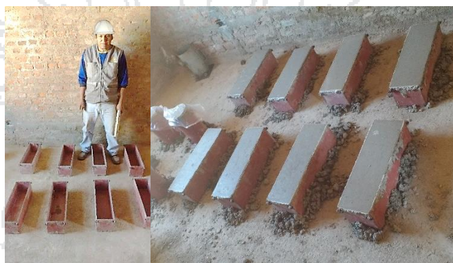
Figura 3. 14 Elaboración de probetas prismáticas para ensayo de flexión
