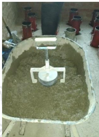
Figura 3. 19 Ensayo de penetración de bola de Kelly
