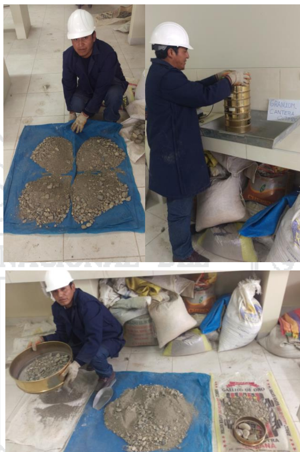
Figura 3. 7 Análisis Granulométrico – A. Fino y A. Grueso
