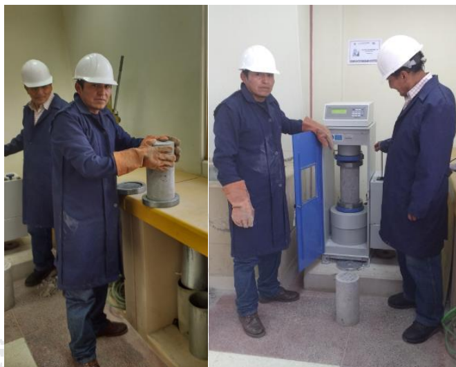
Figura 3. 20 Ensayo de compresión del concreto
