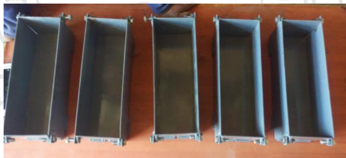
Figura 3. 29 Moldes para los especímenes (vigas de expansión)
