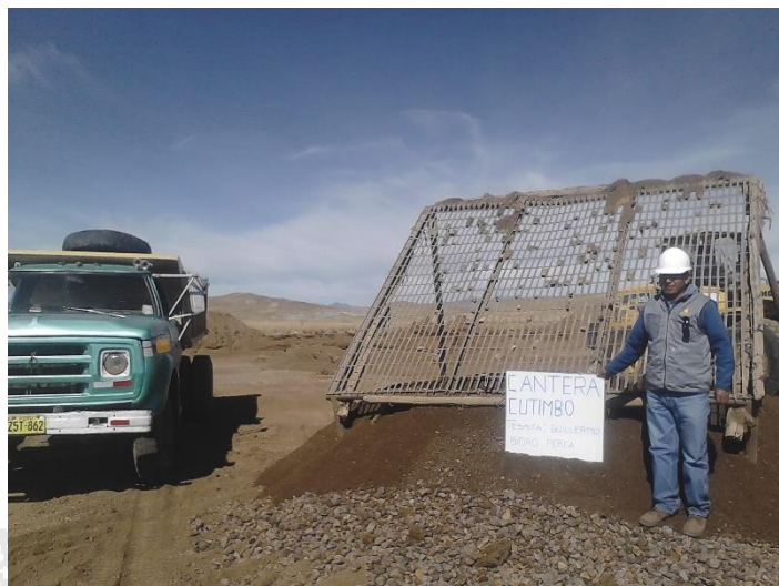
Figura 3. 9 Material de la Cantera de Cutimbo separado por mallas 11/2” y #4.
