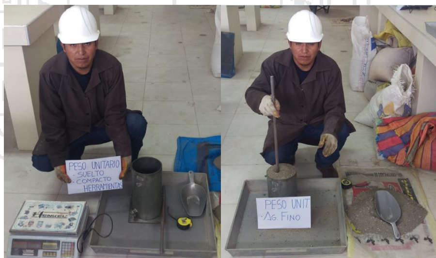
Figura 3. 5 Peso unitario suelto y compacto del agregado fino
