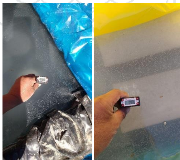
Figura 3. 17 Control de temperatura de curado
