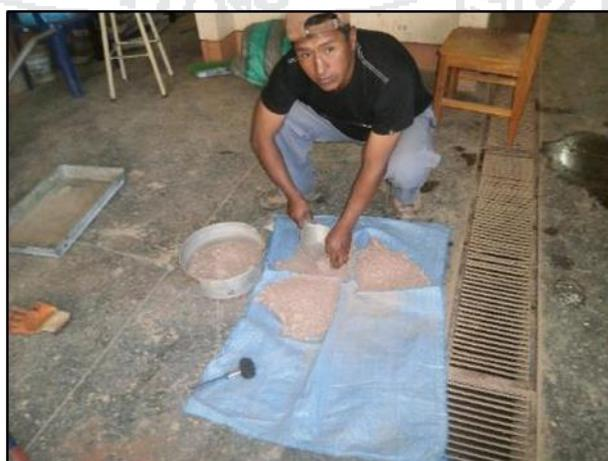
*Figura 9:* cuarteo de muestreo para ensayo de granulometría.
