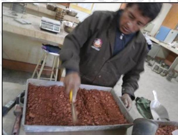
Figura 37: Preparación y humedecimiento para realizar el ensayo de CBR.
