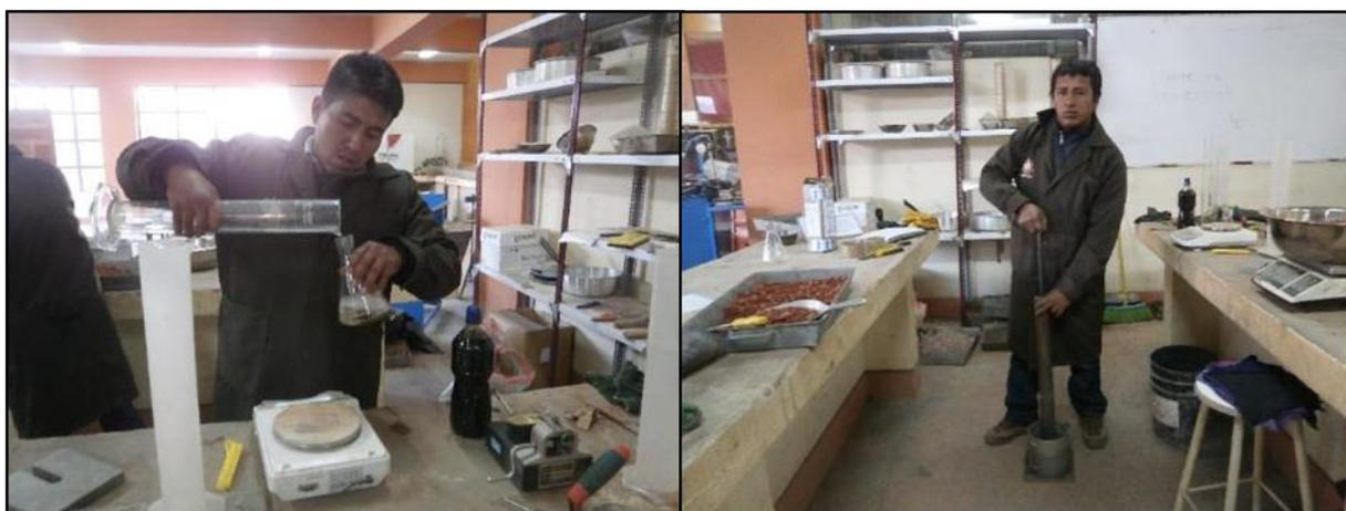
Figura 53: Solución agua-Perma Zyme 30x y compactación de la muestra.
