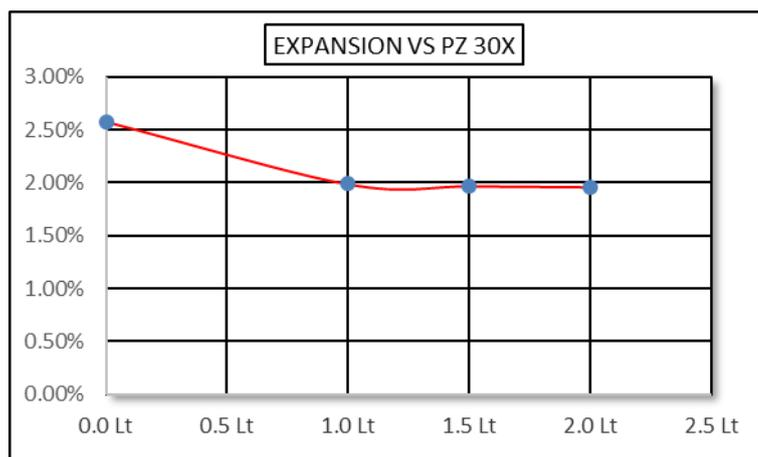
Figura 57: Grafica de Expansión vs dosificación de PZ 30x.
