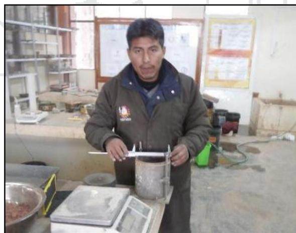
Figura 20: Preparación de muestra y moldes para el ensayo de CBR.
