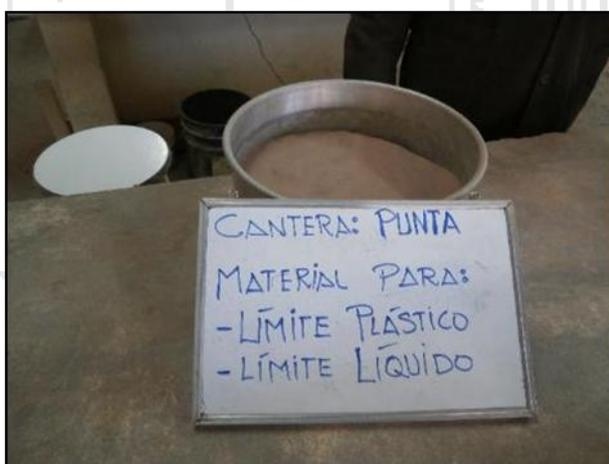
Figura 13: Muestra tamizada del material de cantera punta para los ensayos de L.L. y L.P.
