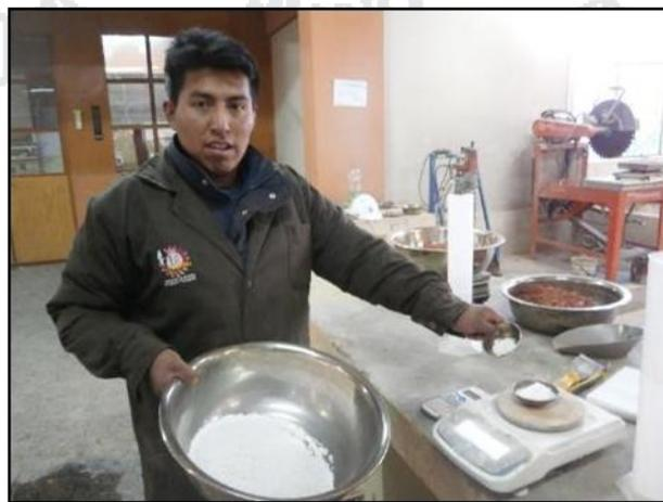
Figura 69: Peso del CaCl<sub>2</sub> para añadir al humedecimiento de la muestra.
