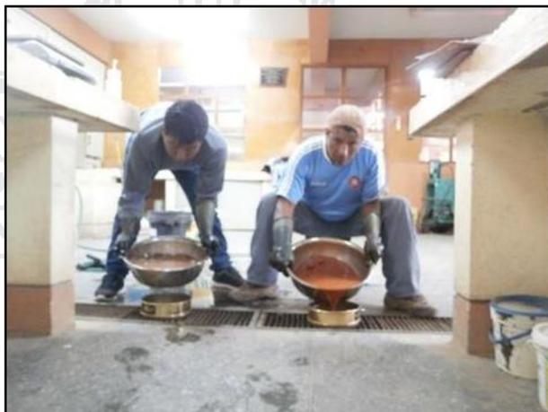
*Figura 10:* Lavado de muestra de la cantera Punta.
