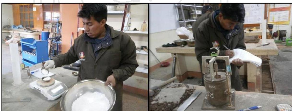
Figura 62: Peso del CaCl<sub>2</sub> y lectura de deformimetro en el ensayo CBR.
