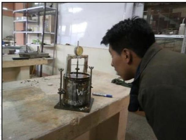
Figura 21: Sobrecargas y deformimetro en las muestras ensayadas del ensayo CBR.
