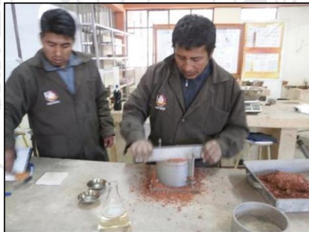
Figura 35: Compactación en el molde y enrasado de la muestra de la cantera Yanahoco.
