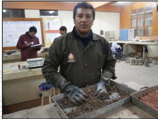
*Figura 17:* Humedecimiento de la muestra de la cantera Punta
