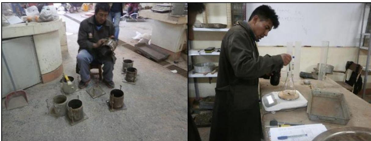
Figura 47: limpieza de molde CBR y peso de aditivo Perma Zyme en gramos
