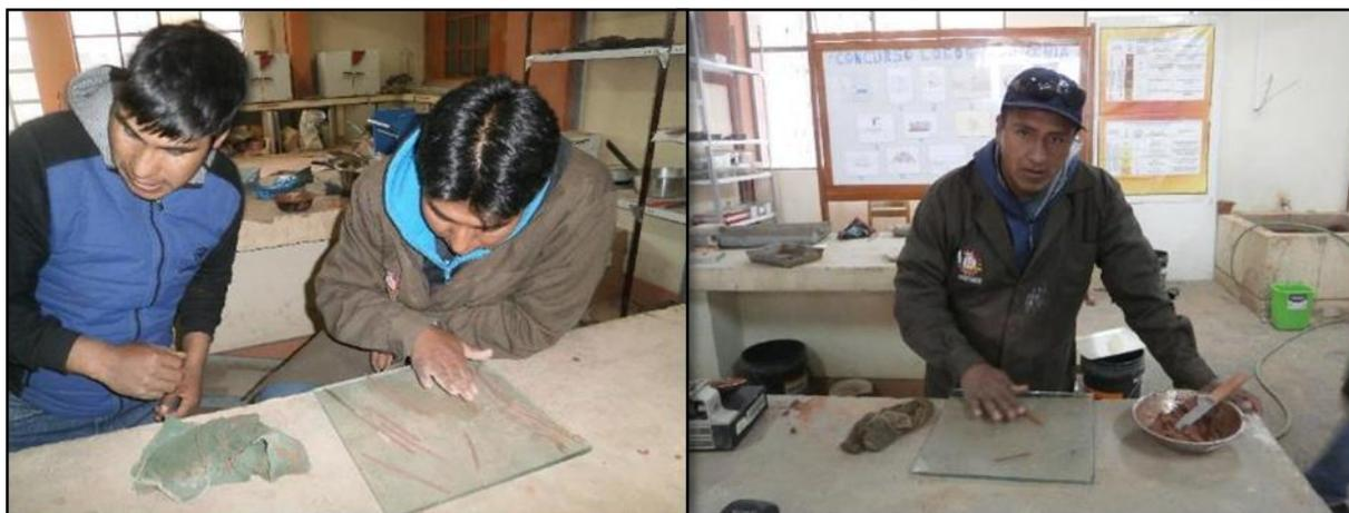
Figura 32: Elaboración de cilindros de 3.2 mm para el ensayo de limite plástico.
