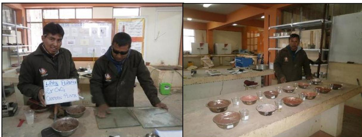
Figura 59: Elaboración de cilindros de 3.2 mm y registro de taras con muestra saturada.
