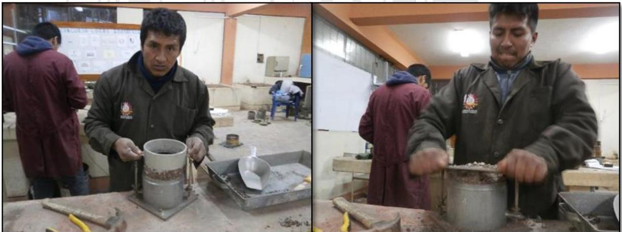
Figura 45: Desprendimiento del collar y enrasado de la muestra del molde del Próctor Modificado.
