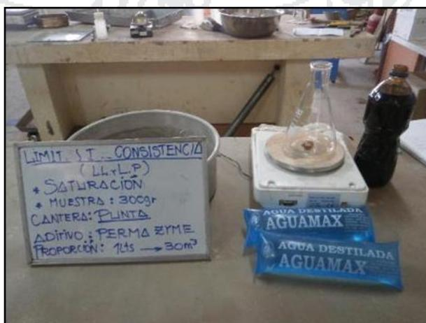
Figura 42: Solución de agua destilada y Perma Zyme con la muestra de la cantera Punta.
