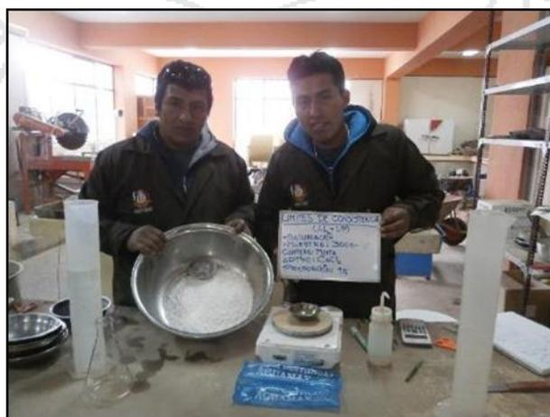
Figura 58: Mezcla de  $\text{CaCl}_2$  y agua destilada con la muestra de la cantera Punta.
