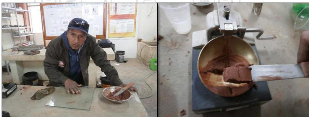
Figura 51: Elaboración de cilindros de 3.2 mm. Y toma de muestra de la cuchara de Casagrande.
