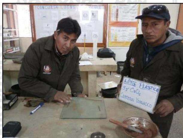
Figura 67: Elaboración de cilindros de 3.2 mm añadiendo CaCl<sub>2</sub> para el L.P.
