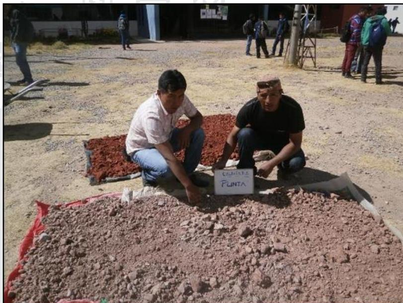
*Figura 8:* Secado de muestra al aire libre de la Cantera Punta.
