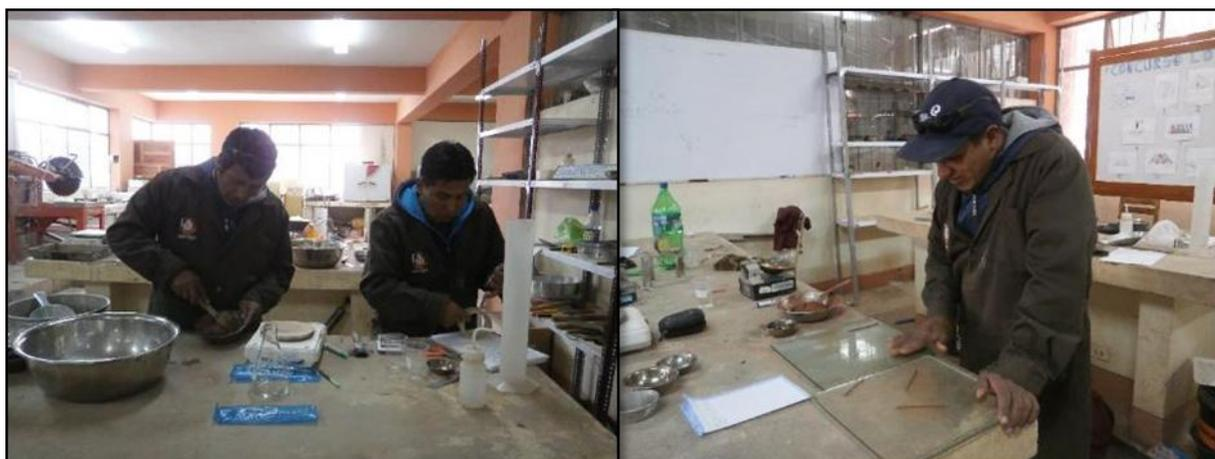
Figura 14: Saturación de muestra con agua destilada y elaboración de cilindros de 3.2 mm de diámetro.
