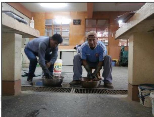
Figura 27: Lavado de muestra de la cantera Yanahoco.
