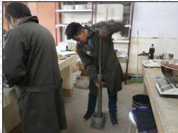
*Figura 18:* Compactación de la muestra en prueba del ensayo Próctor modificado
