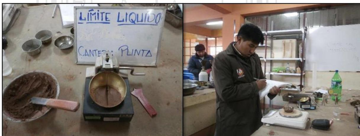
Figura 15: Uso del instrumento de la cuchara de Casagrande y toma de datos para los ensayos de L.L. y L.P.
