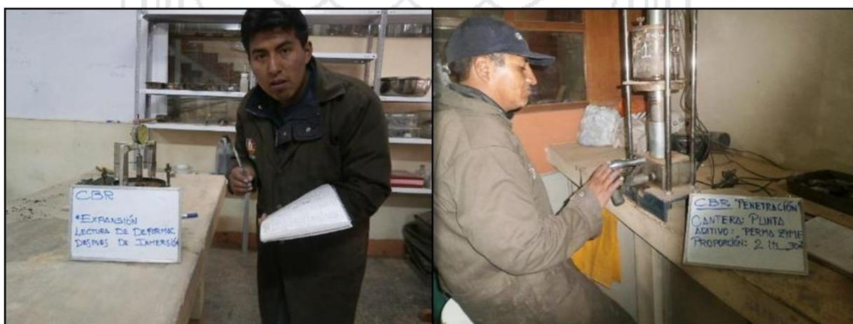
Figura 48: Lectura de expansión después de la inmersión y muestra sometido a pruebas de carga
