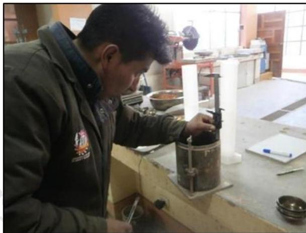
Figura 38: Toma de datos del molde CBR
