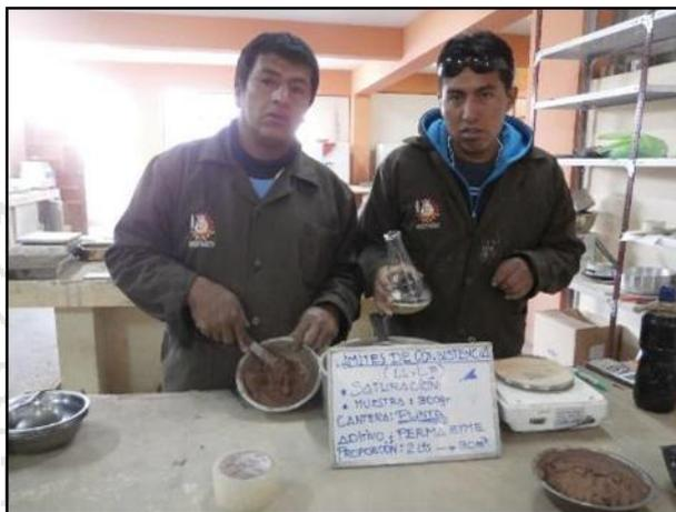
Figura 43: Saturación de muestra con la solución preparada de la muestra de la cantera Punta. Fuente: Elaboración propia.
