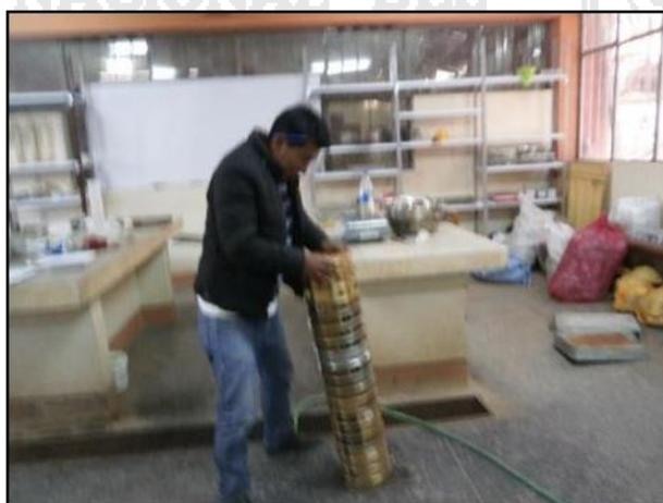
Figura 28: Tamizado de muestra de cantera Punta
