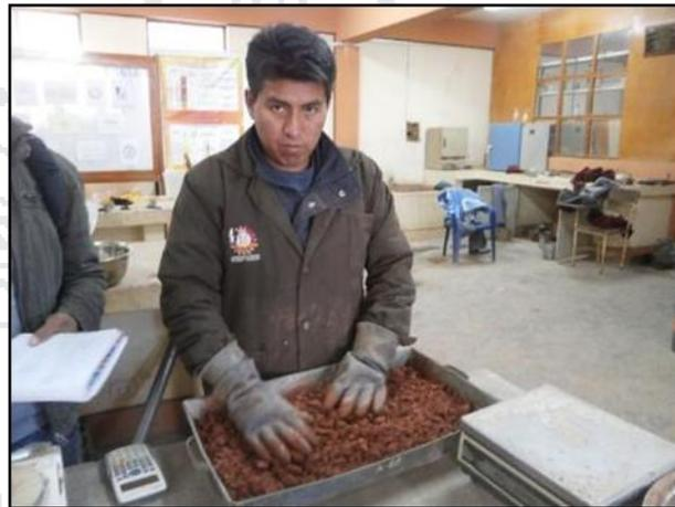
Figura 34: Humedecimiento de la muestra de la cantera Yanahoco.
