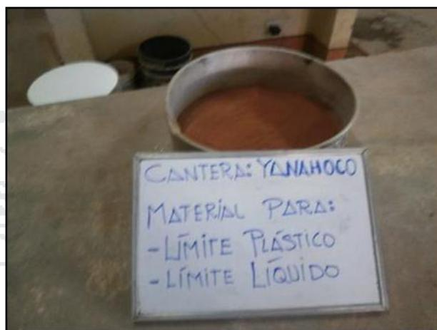
*Figura 30:* Muestra tamizado del material de cantera punta para los ensayos de L.L. y L.P.
