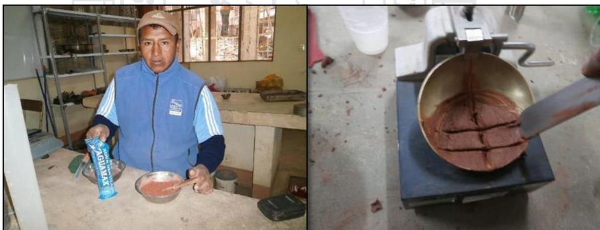
*Figura 31:* Saturación de muestra con agua destilada y uso de la cuchara de Casagrande.
