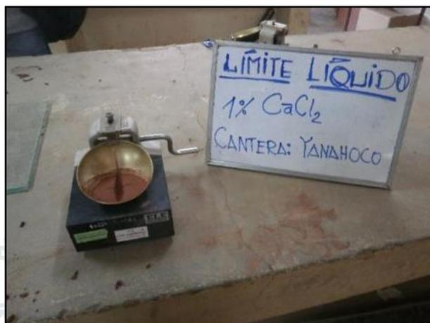
Figura 66: Uso de la cuchara de Casagrande para el límite líquido.
