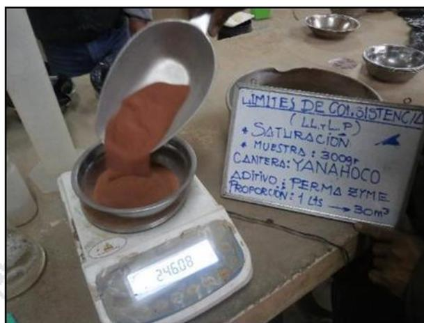
Figura 50: Peso del material para la prueba con 1lt de Perma Zyme para el ensayo del L.L.
