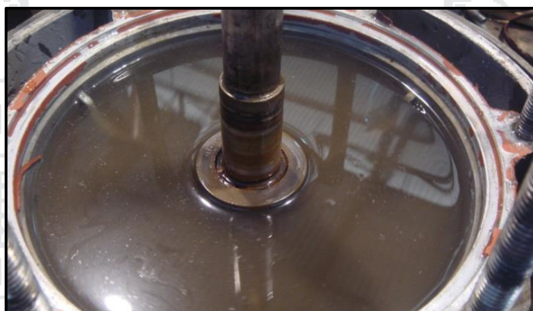
Figura 37. Aceite contaminado con partículas Abrasivas Fuente: Propio
