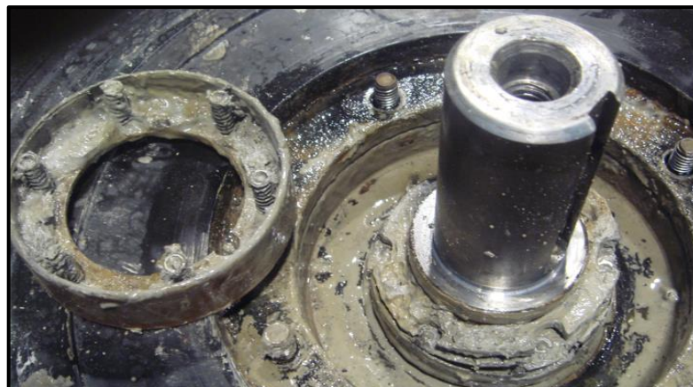
Figura 36. Partículas abrasivas producen pérdida de hermeticidad entre las caras del sello Fuente: Propio
