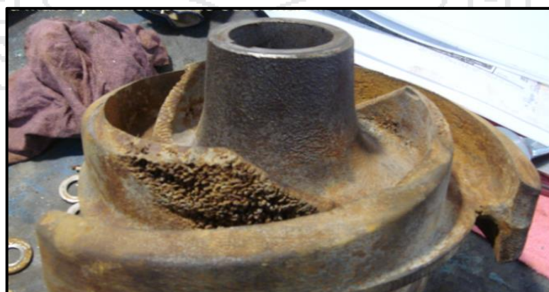
Figura 35. Efecto de cavitación en impulsores. Fuente: Propio
