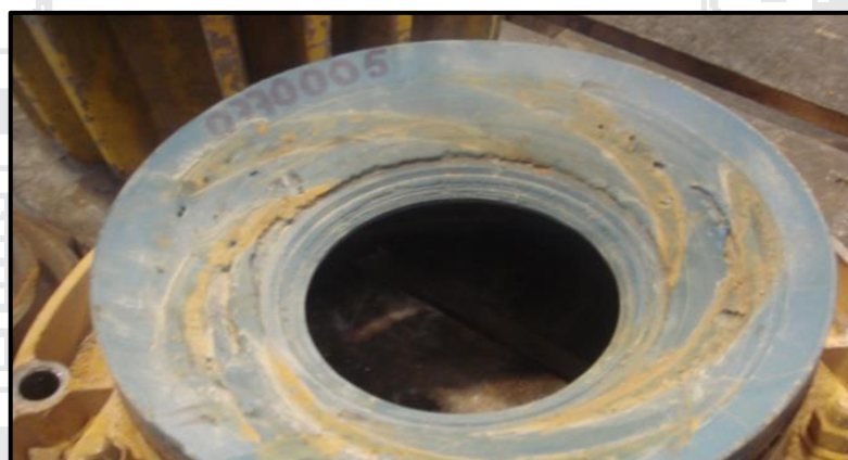
Figura 34. Elevado porcentaje de sólidos en el fluido bombeado Fuente: Propio
