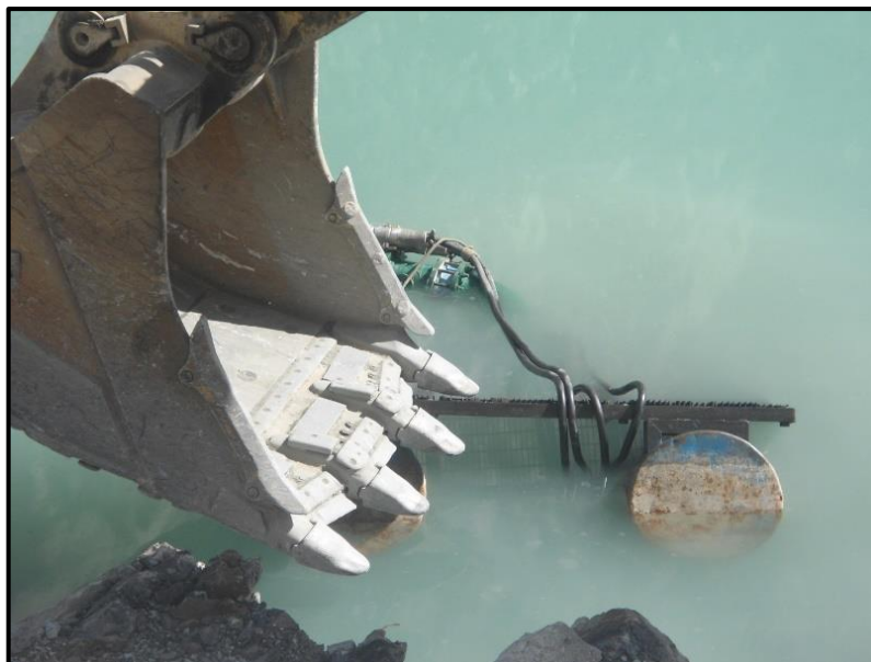
Figura 27. Balsa de bomba volteada Fuente: Propia
