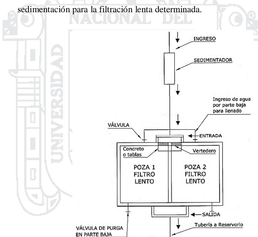
Figura N° 113: Esquema de Planta de Tratamiento Mediante Filtro Lento (García Trisolini, 2009)
