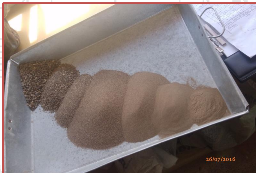
Figura 3.5 Se observa el tamizado del agregado fino
