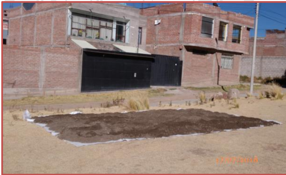
Figura 3.2 Secado del material para la separación de Agregado Fino y Agregado Grueso.
