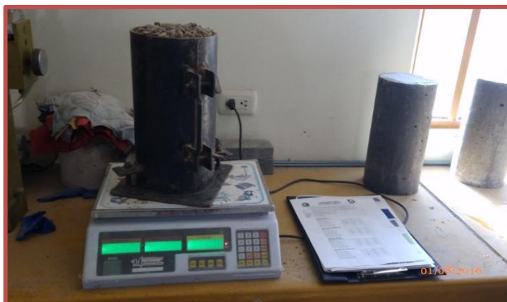
Figura 3.17. Pesado de agregado grueso al recipiente para el cálculo del Peso Unitario Suelto y compactado.
