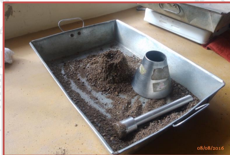
Figura 3.8. Arena superficialmente seca después del apisonado.
