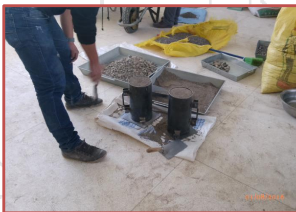
Figura 3.11. Enrasado y pesado del recipiente con la muestra para el cálculo del Peso Unitario Suelto.
