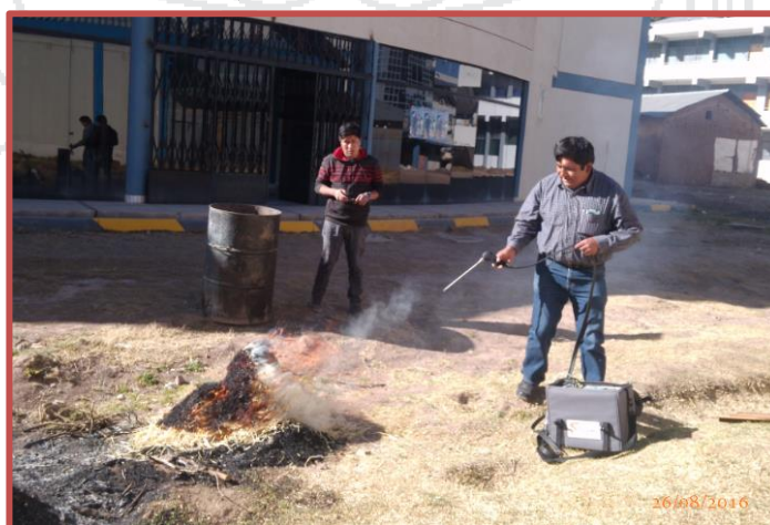
Figura 3.21. Evaluación de la Emisión de Gases al momento de la combustión.
