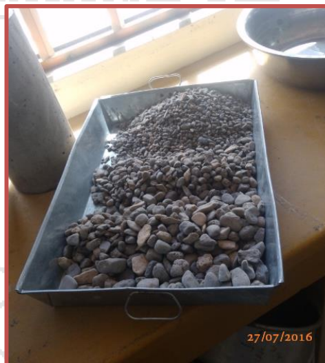
Figura 3.14. Se observa el tamizado del agregado Grueso.
