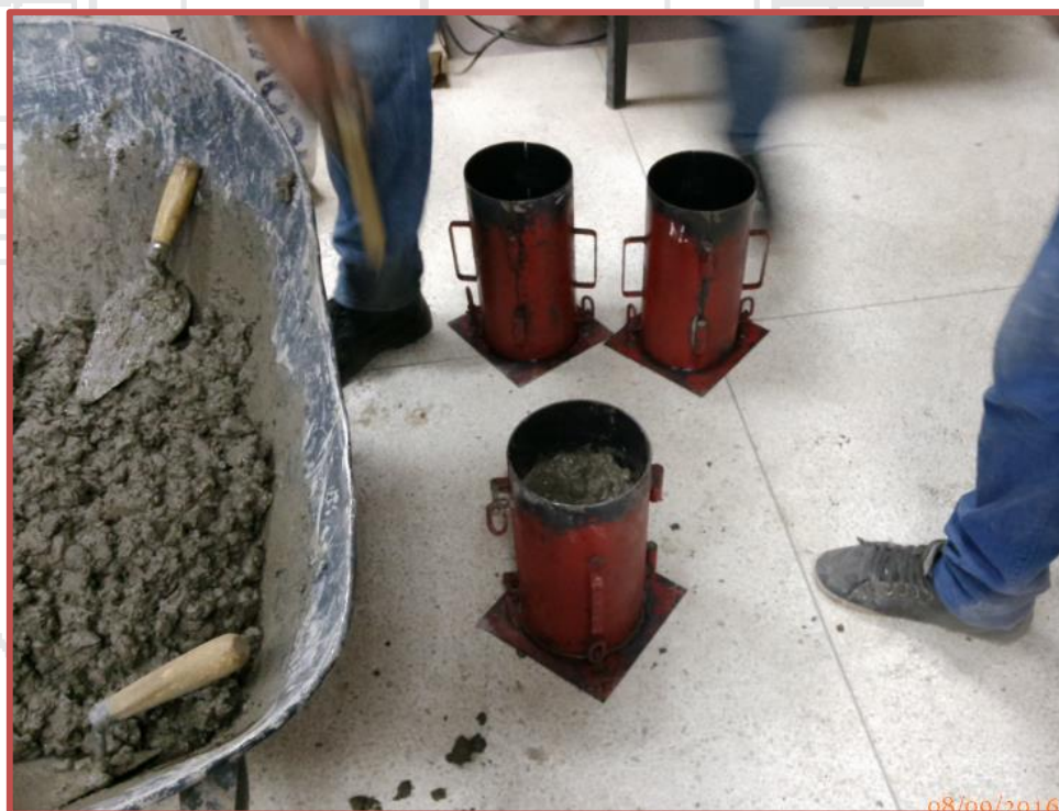
Figura 3.24 Llenado de moldes y apisonado de mezcla de concreto en tres capas iguales.
