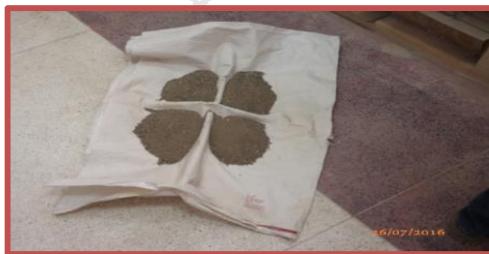
Figura 3.3. Se observa el del agregado fino al momento de realizar el cuarteo.
