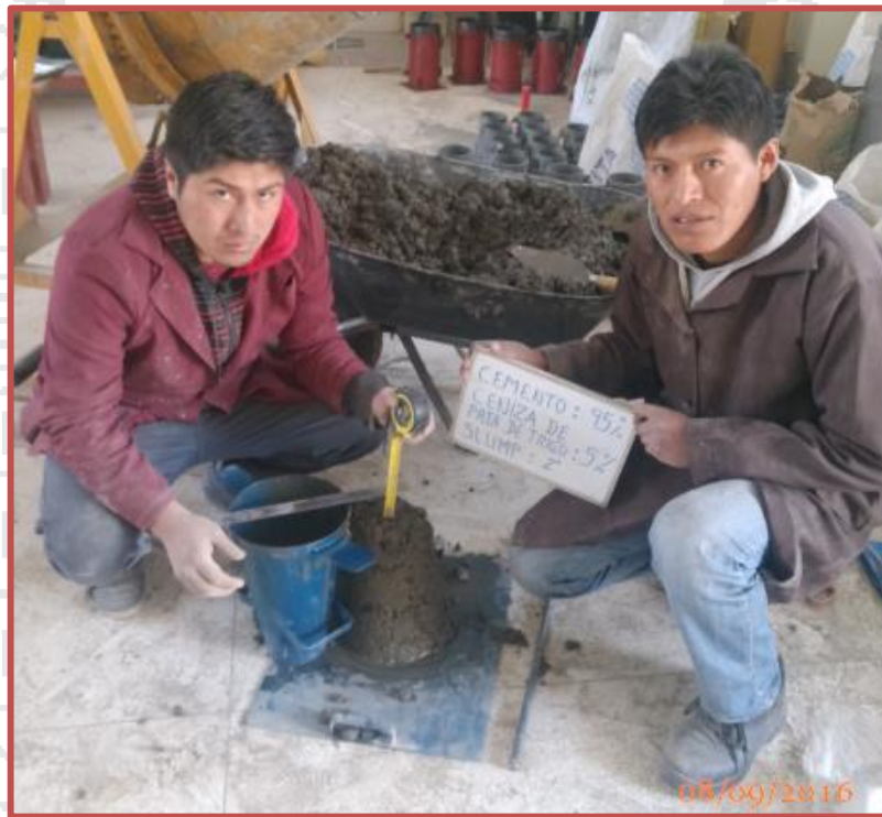
Figura 4.1 Medición del SLUMP en diferentes porcentajes de Cemento y Ceniza.
