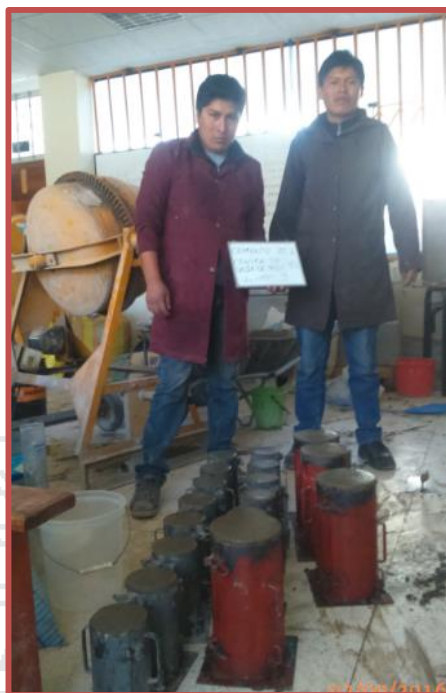
Figura 3.25. Moldes vaciados con concreto, para su posterior desencofrado luego de 24 horas de vaciado.
