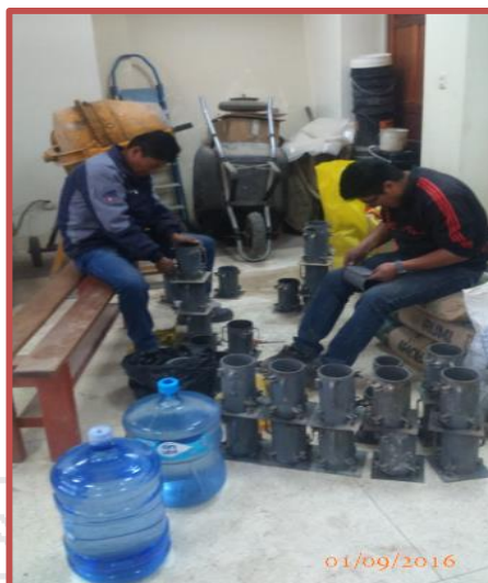
Figura 3.22. Colocado de Tubos de PVC para adaptar a los moldes disponibles en laboratorio.
