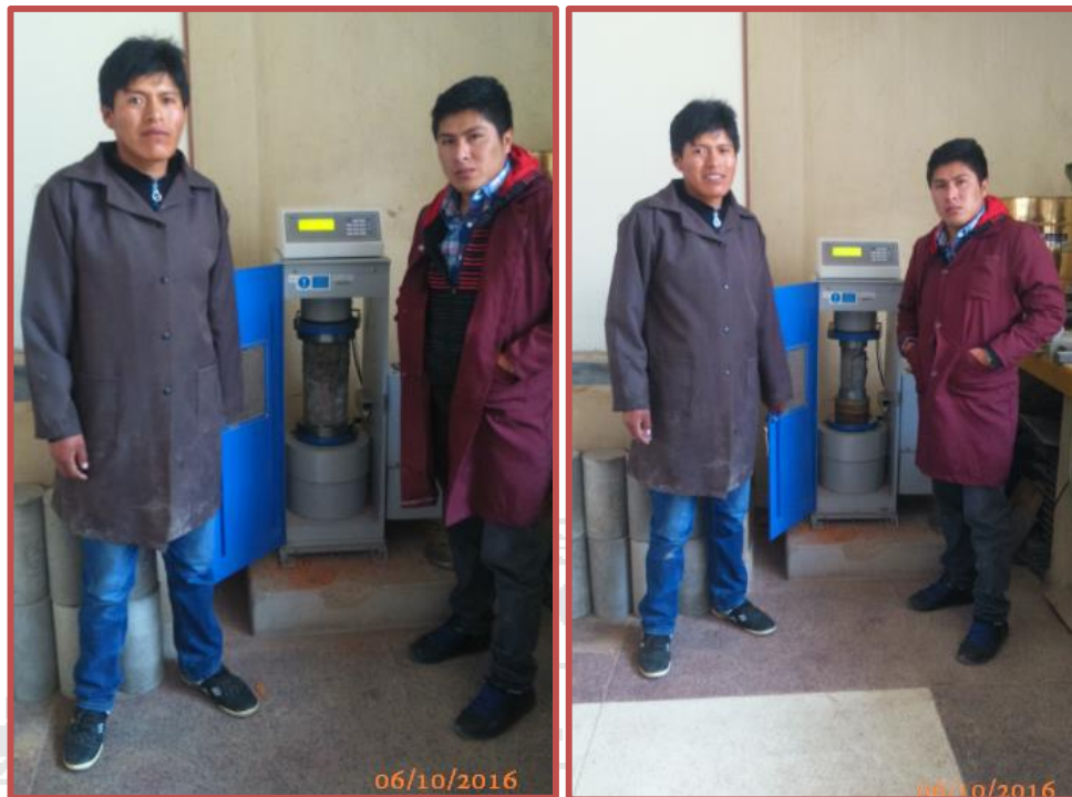
Figura 4.2 Rotura de briquetas de 6"x12" y de 4"x8" respectivamente.
