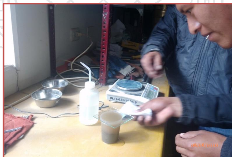
Figura 3.8. Arena superficialmente seca después del apisonado.
