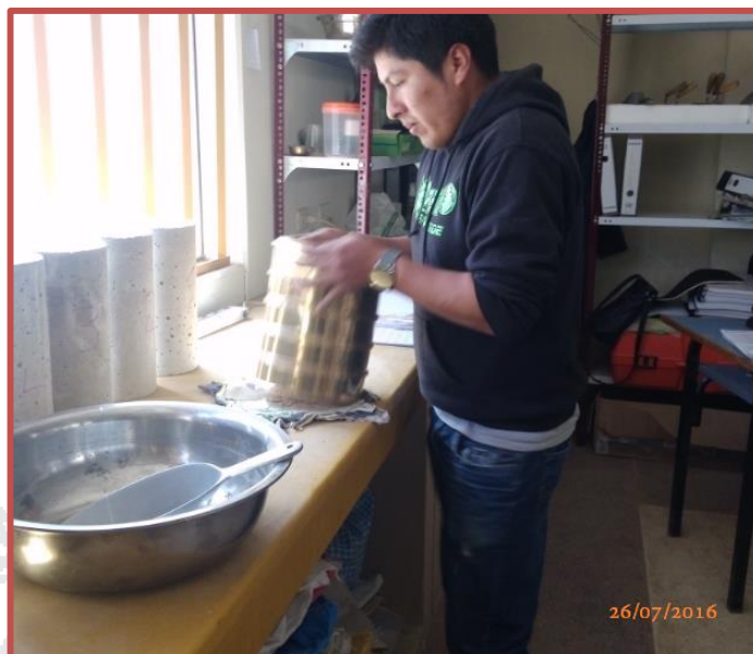
Figura 3.4 Se observa el tamizado del agregado fino.
