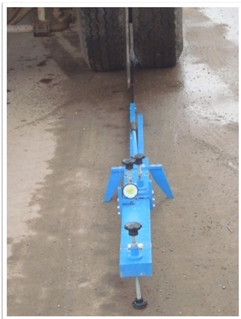
FIGURA N° 05: TÉCNICA DE COLOCADO DE VIGA BENKELMAN
