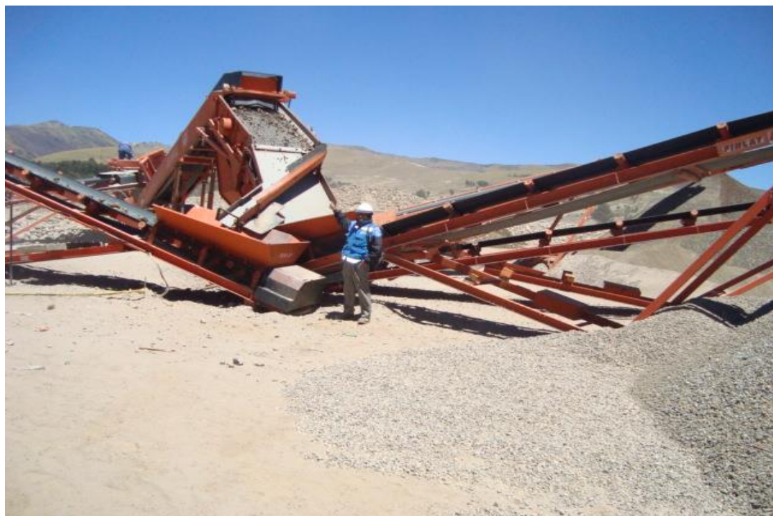
Foto N° 04. Procesamiento de material en planta Cabanillas. (Piedra triturada de 1" a 1/4")
