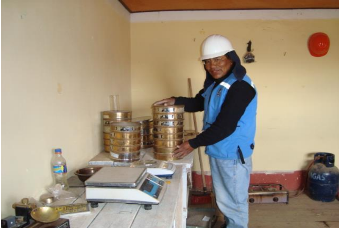
Foto N° 05. Ensayos de granulometría en laboratorio. (Muestra de canteras en estudio)
